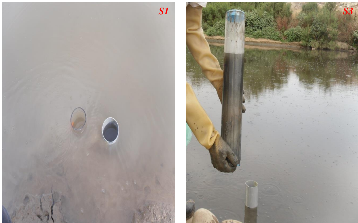
Figure II-9: Prélèvement des carottes de sédiment dans S1 (A) et S3 (B)
