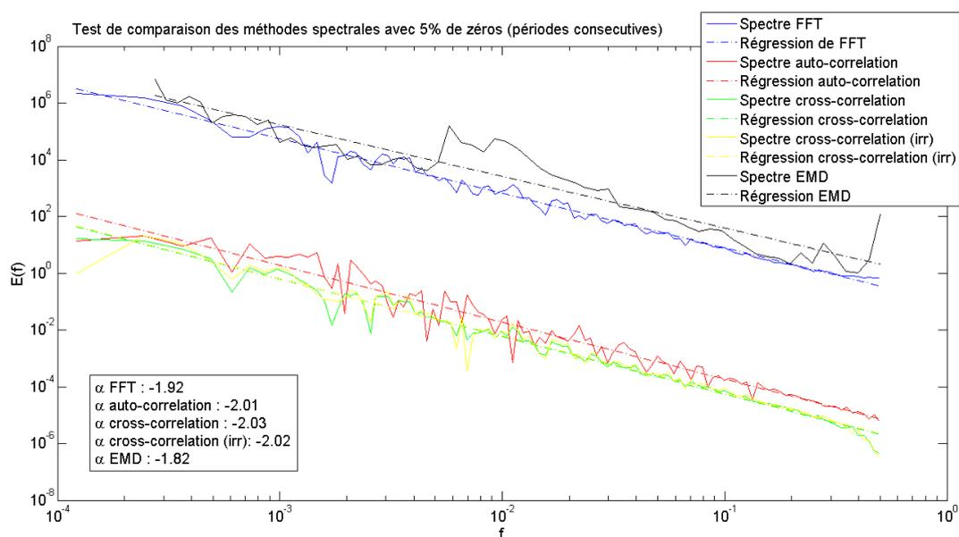
**Figure 4-8.** Comparaison de différentes méthodes spectrales réalisées sur un mouvement brownien dégradé avec 5% de zéros répartis de manière consécutive. La correspondance entre les couleurs et les méthodes est la suivante : bleu FFT ; rouge auto-corrélation ; vert cross-corrélation ; jaune cross-corrélation (irrégulière) ; noir EMD-HSA.
