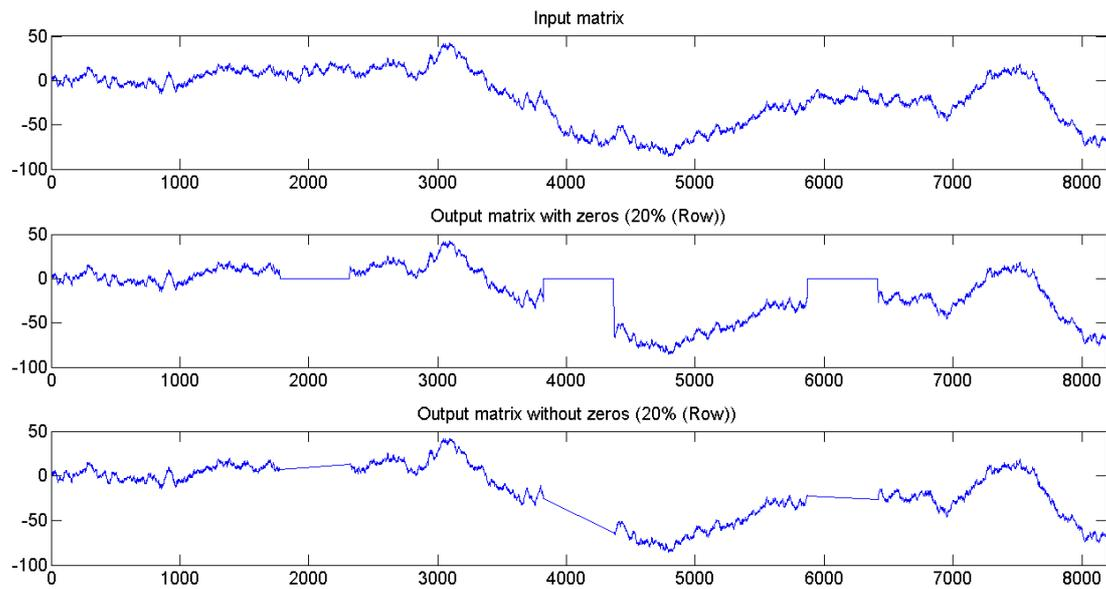
**Figure 4-6.** Visualisation du mouvement brownien avec 20% de dégradation du signal réparti entre 3 périodes consécutives. En haut : mouvement brownien non dégradé. Au milieu : période manquante remplacée par des zéros. En bas : périodes manquantes.
