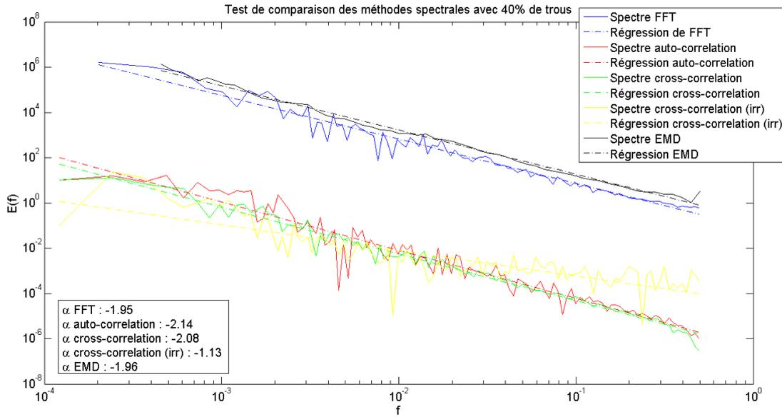
**Figure 4-42.** Comparaison de différentes méthodes spectrales réalisées sur un mouvement brownien dégradé avec 40% de périodes manquantes réparties de manière aléatoire. La correspondance entre les couleurs et les méthodes est la suivante : bleu FFT ; rouge auto-corrélation ; vert cross-corrélation; jaune cross-corrélation (irrégulière) ; noir EMD-HSA.
