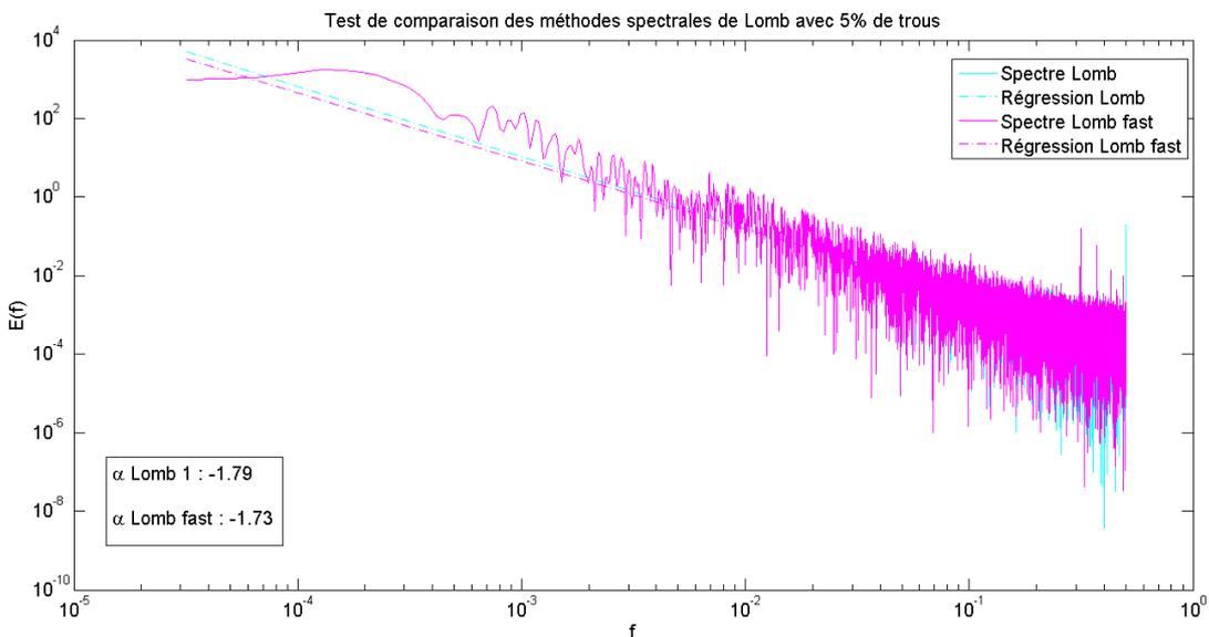
**Figure 4-37.** Comparaison des méthodes de Lomb classique (en cyan) et Fast Lomb (en magenta), réalisées sur un mouvement brownien dégradé avec 5% de périodes manquantes réparties de manière aléatoire.
