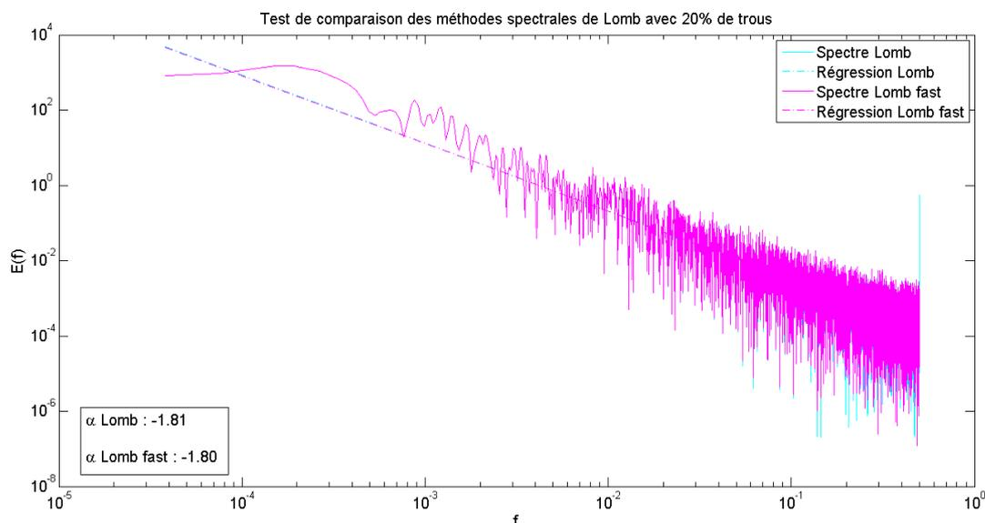
**Figure 4-41.** Comparaison des méthodes de Lomb classique (en cyan) et Fast Lomb (en magenta), réalisées sur un mouvement brownien dégradé avec 20% de périodes manquantes réparties de manière aléatoire.
