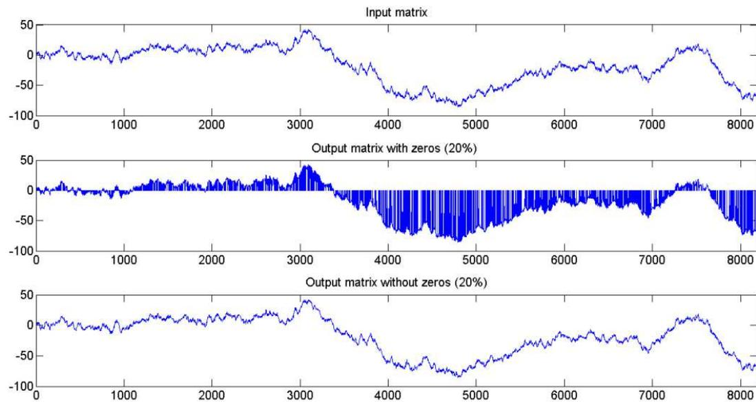
**Figure 4-26.** Visualisation du mouvement brownien avec 20% de dégradation du signal répartie aléatoirement. En haut : mouvement brownien non dégradé. Au milieu : valeurs manquantes remplacées par des zéros. En bas : valeurs manquantes.
