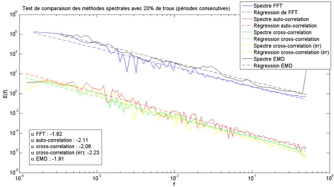
**Figure 4-20.** Comparaison de différentes méthodes spectrales réalisées sur un mouvement brownien dégradé avec 20% de périodes manquantes réparties de manière consécutive. La correspondance entre les couleurs et les méthodes est la suivante : bleu FFT ; rouge auto-corrélation ; vert cross-corrélation; jaune cross-corrélation (irrégulière) ; noir EMD-HSA.
