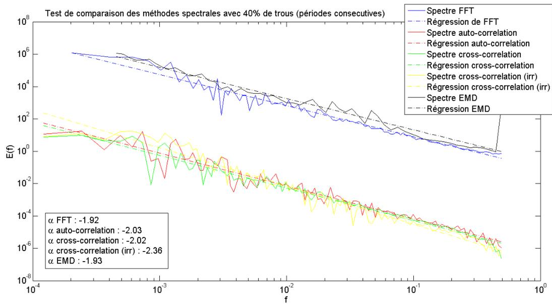
**Figure 4-22.** Comparaison de différentes méthodes spectrales réalisées sur un mouvement brownien dégradé avec 40% de périodes manquantes réparties de manière consécutive. La correspondance entre les couleurs et les méthodes est la suivante : bleu FFT ; rouge auto-corrélation ; vert cross-corrélation; jaune cross-corrélation (irrégulière) ; noir EMD-HSA.
