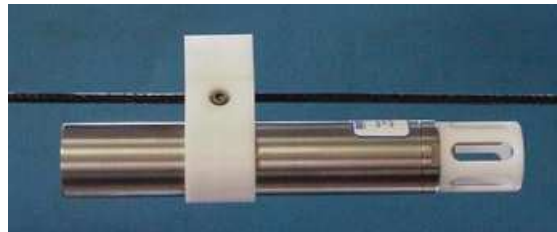
Figure 1-7. Photographie de la sonde SBE39. (source : Pascal Morin)
