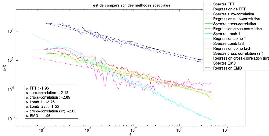
**Figure 4-2.** Test de comparaison des différentes méthodes spectrales réalisé sur un mouvement brownien non dégradé. La correspondance entre les couleurs et les méthode est la suivante : bleu FFT ; rouge auto-corrélation ; vert cross-corrélation ; cyan Lomb ; violet Fast Lomb ; jaune cross-corrélation (irrégulière) ; noir EMD-HSA.
