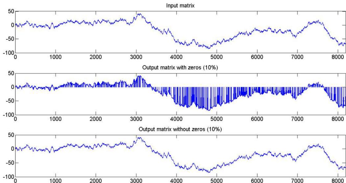
**Figure 4-25.** Visualisation du mouvement brownien avec 10% de dégradation du signal répartie aléatoirement. En haut : mouvement brownien non dégradé. Au milieu : valeurs manquantes remplacées par des zéros. En bas : valeurs manquantes.
