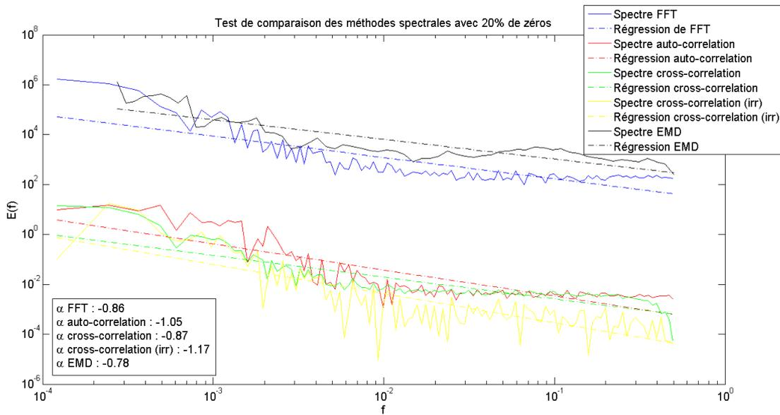
**Figure 4-32.** Comparaison de différentes méthodes spectrales réalisées sur un mouvement brownien dégradé avec 20% de zéros répartis de manière aléatoire. La correspondance entre les couleurs et les méthodes est la suivante : bleu FFT ; rouge auto-corrélation ; vert cross-corrélation ; jaune cross-corrélation (irrégulière) ; noir EMD-HSA.
