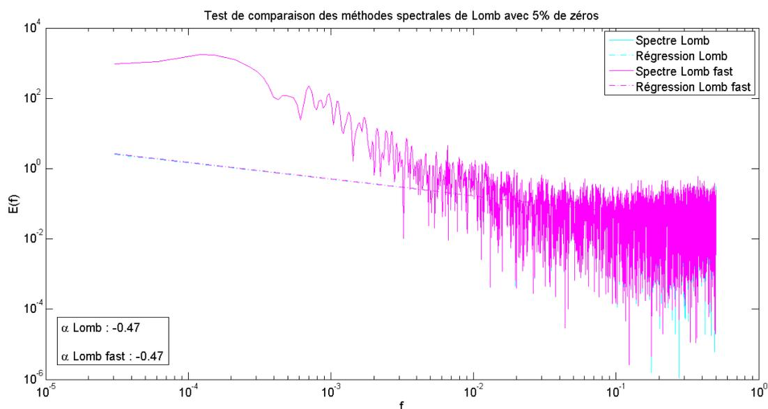
**Figure 4-29.** Comparaison des méthodes de Lomb classique (en cyan) et Fast Lomb (en magenta), réalisées sur un mouvement brownien dégradé avec 5% de zéros répartis de manière aléatoire.
