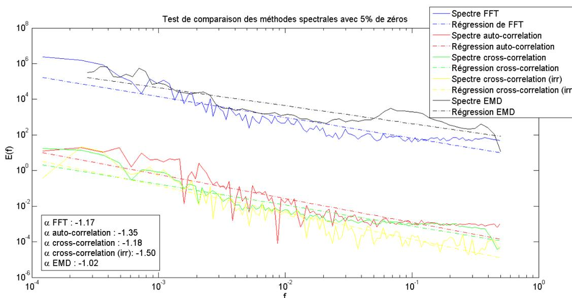
**Figure 4-28.** Comparaison de différentes méthodes spectrales réalisées sur un mouvement brownien dégradé avec 5% de zéros répartis de manière aléatoire. La correspondance entre les couleurs et les méthodes est la suivante : bleu FFT ; rouge auto-corrélation ; vert cross-corrélation ; jaune cross-corrélation (irrégulière) ; noir EMD-HSA.
