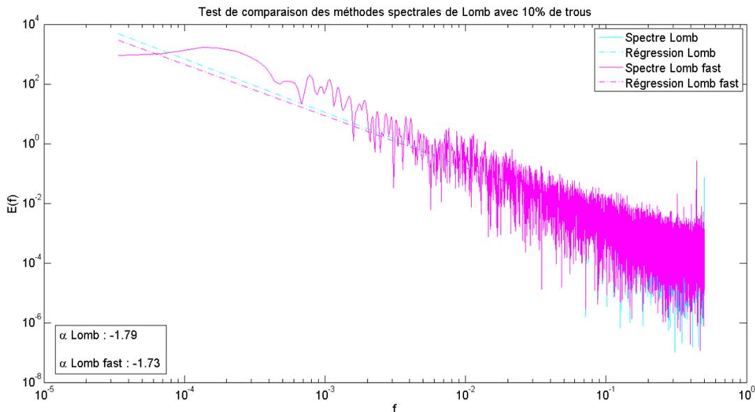
**Figure 4-39.** Comparaison des méthodes de Lomb classique (en cyan) et Fast Lomb (en magenta), réalisées sur un mouvement brownien dégradé avec 10% de périodes manquantes réparties de manière aléatoire.
