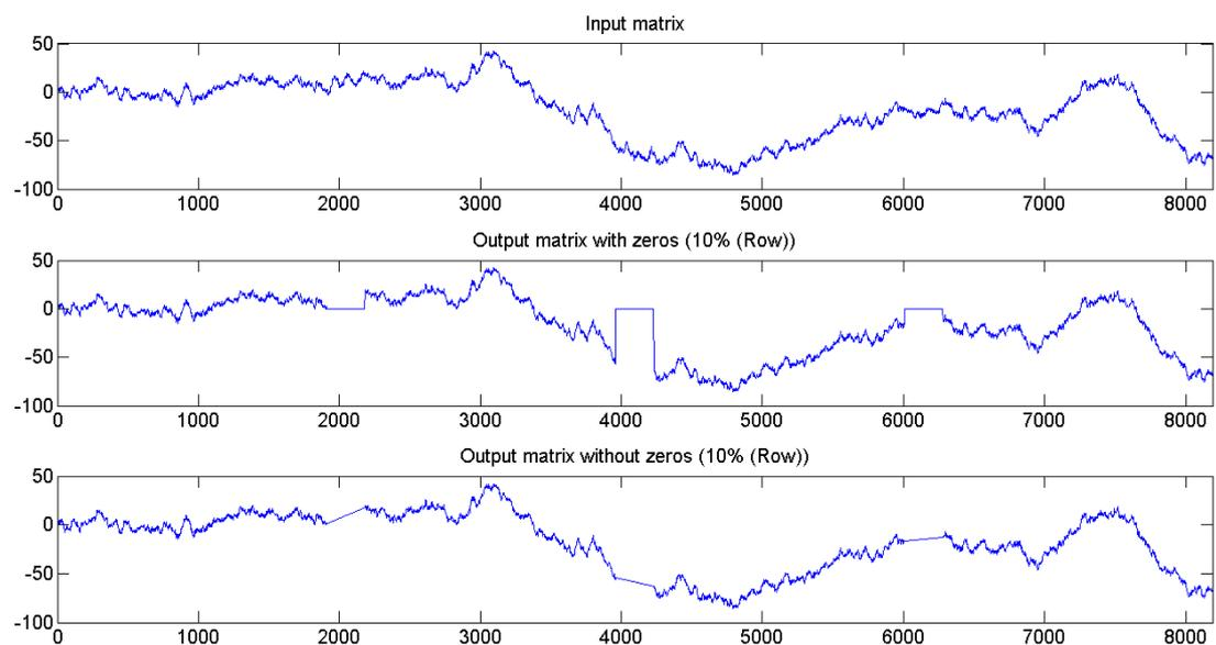
**Figure 4-5.** Visualisation du mouvement brownien avec 10% de dégradation du signal réparti entre 3 périodes consécutives. En haut : mouvement brownien non dégradé. Au milieu : période manquante remplacée par des zéros. En bas : périodes manquantes.
