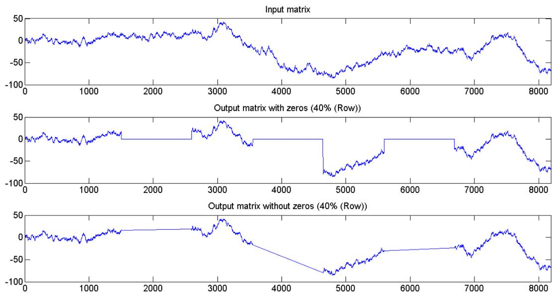
**Figure 4-7.** Visualisation du mouvement brownien avec 40% de dégradation du signal réparti entre 3 périodes consécutives. En haut : mouvement brownien non dégradé. Au milieu : période manquante remplacée par des zéros. En bas : périodes manquantes.
