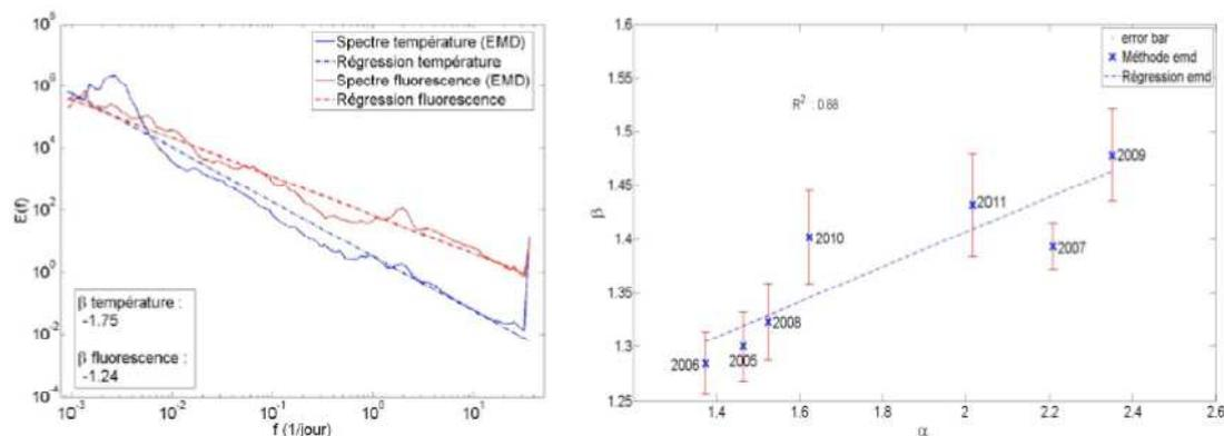
**Figure 5.** (Gauche) Pente spectrale des données de température et de fluorescence, estimées à partir de la méthode EMD. (Droite) Représentation de la pente spectrale de la fluorescence pendant les hivers pré-blooms, estimée par la méthode EMD, en fonction de la pente de la PDF hyperbolique des données de fluorescence au cours de l'année suivante.
