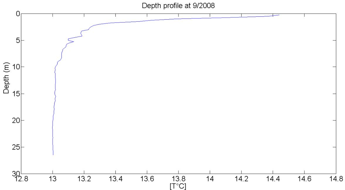
**Figure 2-37.** Profil des températures SOMLIT pour le point côte en septembre 2008. Ceci correspond à une couche de mélange (mixed layer) d'environ 10m, avec une différence d'environ 1,4°C, soit 0,14°C/m.
