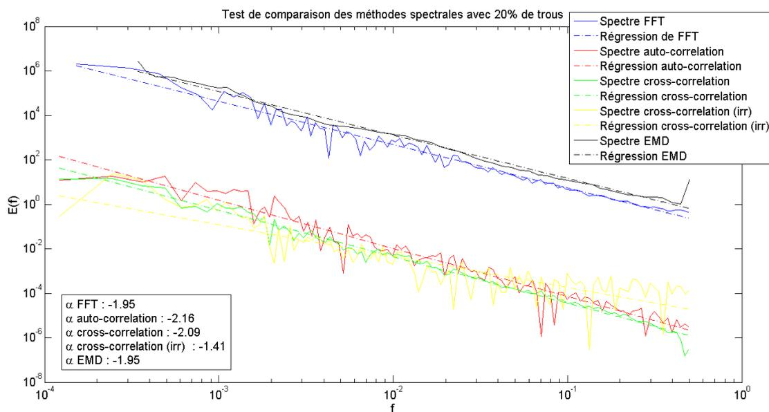
**Figure 4-40.** Comparaison de différentes méthodes spectrales réalisées sur un mouvement brownien dégradé avec 20% de périodes manquantes réparties de manière aléatoire. La correspondance entre les couleurs et les méthodes est la suivante : bleu FFT ; rouge auto-corrélation ; vert cross-corrélation; jaune cross-corrélation (irrégulière) ; noir EMD-HSA.
