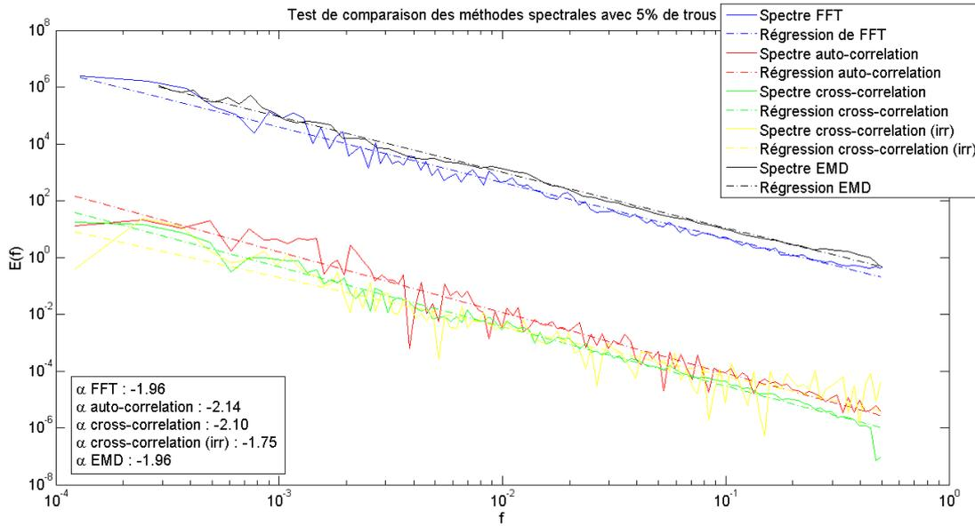
**Figure 4-36.** Comparaison de différentes méthodes spectrales réalisées sur un mouvement brownien dégradé avec 5% de périodes manquantes réparties de manière aléatoire. La correspondance entre les couleurs et les méthodes est la suivante : bleu FFT ; rouge auto-corrélation ; vert cross-corrélation; jaune cross-corrélation (irrégulière) ; noir EMD-HSA.
