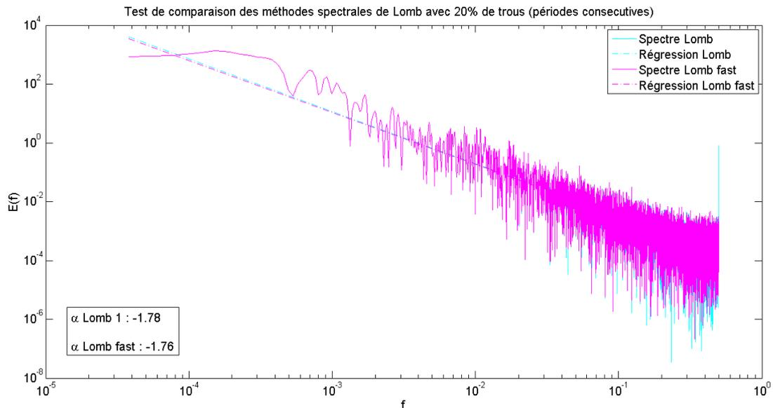
**Figure 4-21.** Comparaison des méthodes de Lomb classique (en cyan) et Fast Lomb (en magenta), réalisées sur un mouvement brownien dégradé avec 20% de périodes manquante réparties de manière consécutive.
