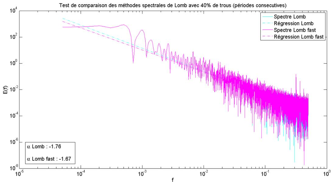
**Figure 4-23.** Comparaison des méthodes de Lomb classique (en cyan) et Fast Lomb (en magenta), réalisées sur un mouvement brownien dégradé avec 40% de périodes manquantes réparties de manière consécutive.
