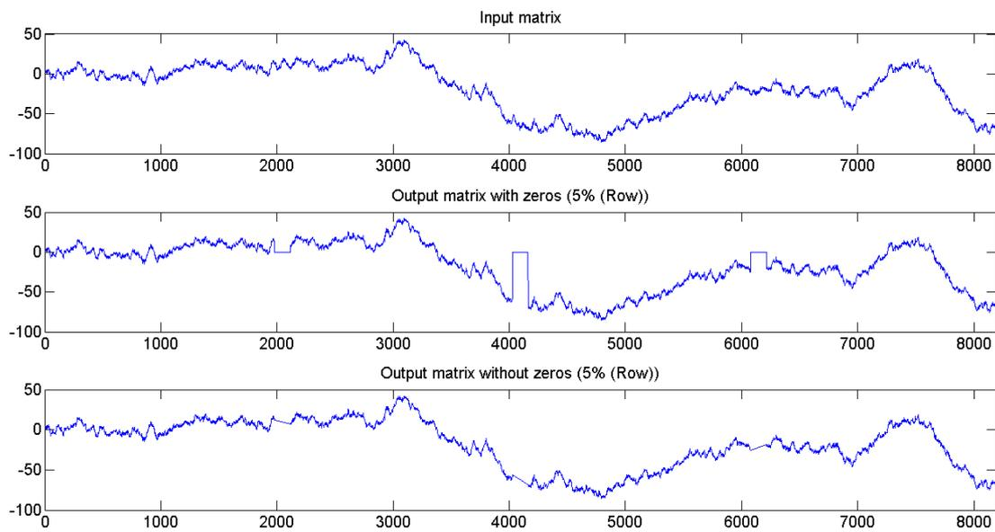
**Figure 4-4.** Visualisation du mouvement brownien avec 5% de dégradation du signal réparti entre 3 périodes consécutives. En haut : mouvement brownien non dégradé. Au milieu : période manquante remplacée par des zéros. En bas : périodes manquantes.
