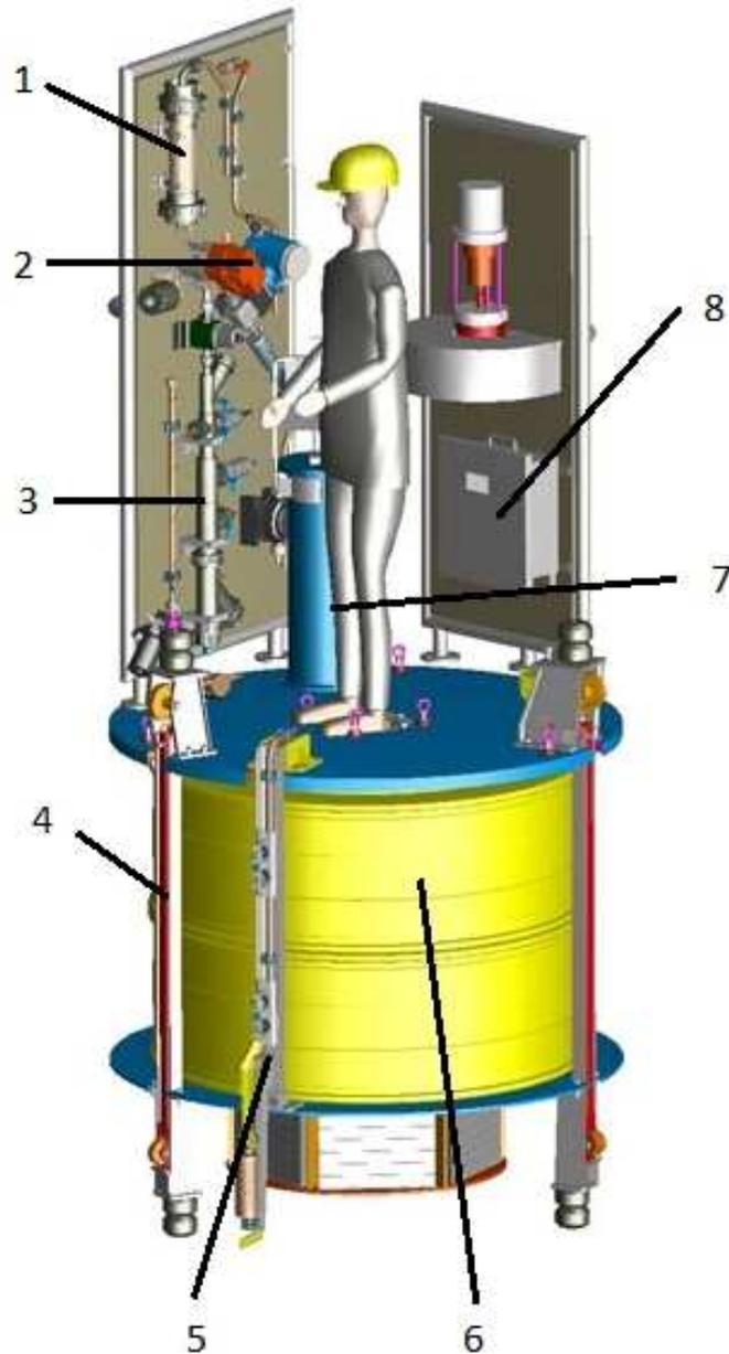
**Figure 1-4.** Représentation schématique du dispositif placé à l'intérieur du tube de MAREL Carnot. (1) Débulleur ; (2) Vanne et débitmètre ; (3) Chambre de mesures des paramètres physico-chimiques et système d'antifouling ; (4) Système de roulement ; (5) Perche de prélèvement ; (6) Flotteur ; (7) Analyseur de nutriments ; (8) Automate de la station de mesures.
