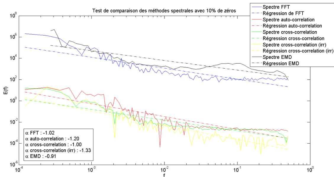
**Figure 4-30.** Comparaison de différentes méthodes spectrales réalisées sur un mouvement brownien dégradé avec 10% de zéros répartis de manière aléatoire. La correspondance entre les couleurs et les méthodes est la suivante : bleu FFT ; rouge auto-corrélation ; vert cross-corrélation; jaune cross-corrélation (irrégulière) ; noir EMD-HSA.
