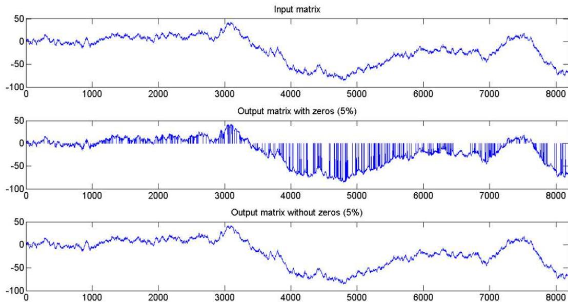
**Figure 4-24.** Visualisation du mouvement brownien avec 5% de dégradation du signal répartie aléatoirement. En haut : mouvement brownien non dégradé. Au milieu : valeurs manquantes remplacées par des zéros. En bas : valeurs manquantes.
