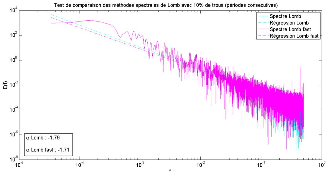
**Figure 4-19.** Comparaison des méthodes de Lomb classique (en cyan) et Fast Lomb (en magenta), réalisées sur un mouvement brownien dégradé avec 10% de périodes manquante réparties de manière consécutive.
