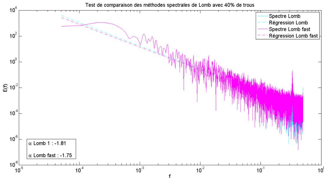
**Figure 4-43.** Comparaison des méthodes de Lomb classique (en cyan) et Fast Lomb (en magenta), réalisées sur un mouvement brownien dégradé avec 40% de périodes manquantes réparties de manière aléatoire.
