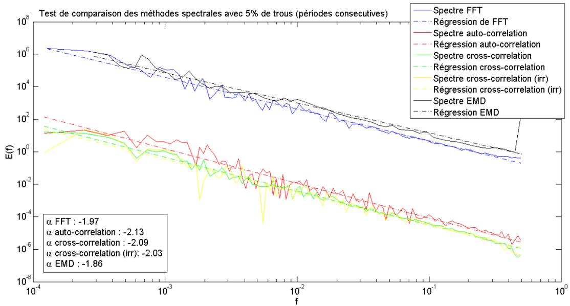
**Figure 4-16.** Comparaison de différentes méthodes spectrales réalisées sur un mouvement brownien dégradé avec 5% de périodes manquantes réparties de manière consécutive. La correspondance entre les couleurs et les méthodes est la suivante : bleu FFT ; rouge auto-corrélation ; vert cross-corrélation; jaune cross-corrélation (irrégulière) ; noir EMD-HSA.
