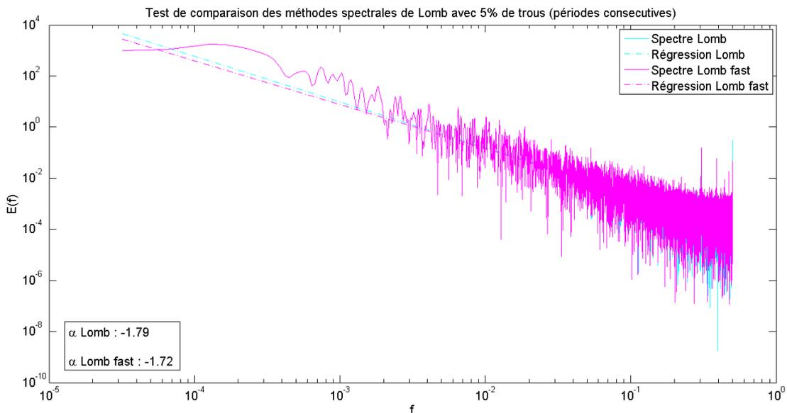
**Figure 4-17.** Comparaison des méthodes de Lomb classique (en cyan) et Fast Lomb (en magenta), réalisées sur un mouvement brownien dégradé avec 5% de périodes manquante réparties de manière consécutive.
