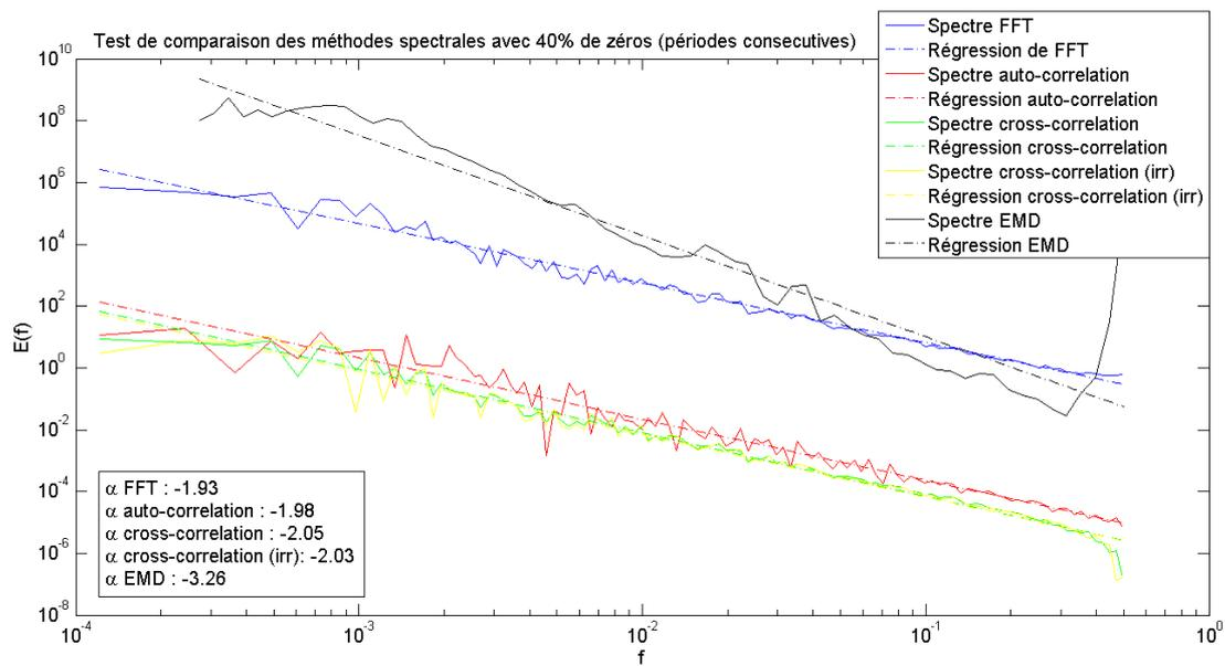
**Figure 4-14.** Comparaison de différentes méthodes spectrales réalisées sur un mouvement brownien dégradé avec 40% de zéros répartis de manière consécutive. La correspondance entre les couleurs et les méthode est la suivante : bleu FFT ; rouge auto-corrélation ; vert cross-corrélation; jaune cross-corrélation (irrégulière) ; noir EMD-HSA.
