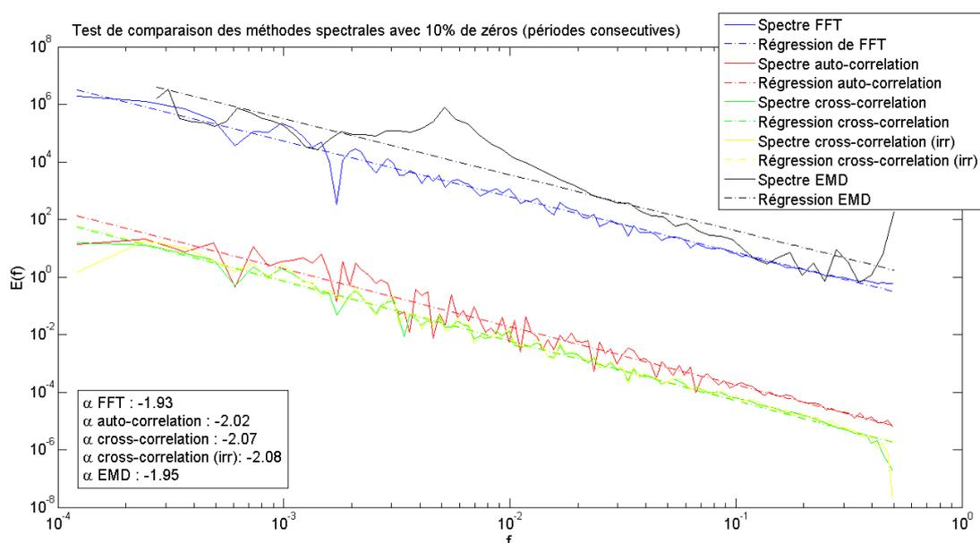
**Figure 4-10.** Comparaison de différentes méthodes spectrales réalisées sur un mouvement brownien dégradé avec 10% de zéros répartis de manière consécutive. La correspondance entre les couleurs et les méthodes est la suivante : bleu FFT ; rouge auto-corrélation ; vert cross-corrélation ; jaune cross-corrélation (irrégulière) ; noir EMD-HSA.
