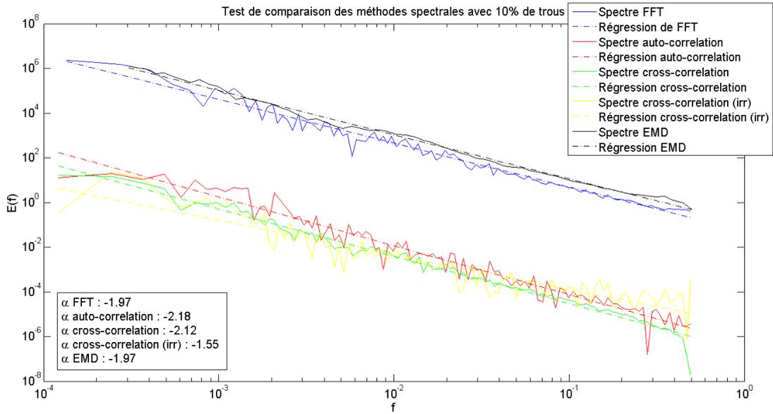
**Figure 4-38.** Comparaison de différentes méthodes spectrales réalisées sur un mouvement brownien dégradé avec 10% de périodes manquantes réparties de manière aléatoire. La correspondance entre les couleurs et les méthodes est la suivante : bleu FFT ; rouge auto-corrélation ; vert cross-corrélation; jaune cross-corrélation (irrégulière) ; noir EMD-HSA.
