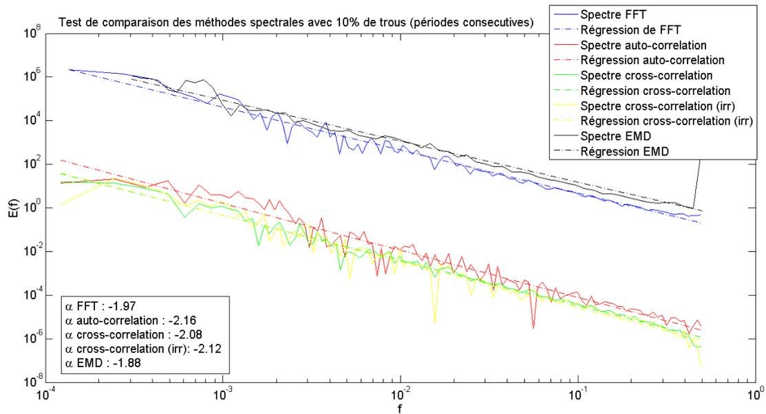
**Figure 4-18.** Comparaison de différentes méthodes spectrales réalisées sur un mouvement brownien dégradé avec 10% de périodes manquantes réparties de manière consécutive. La correspondance entre les couleurs et les méthodes est la suivante : bleu FFT ; rouge auto-corrélation ; vert cross-corrélation; jaune cross-corrélation (irrégulière) ; noir EMD-HSA.
