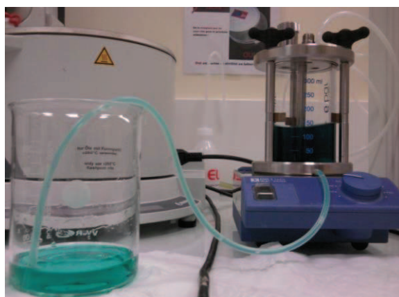
Figure 194. Photographie du montage d'ultrafiltration en cours de lavage du nanohybride TiONts – Pc peptidique
