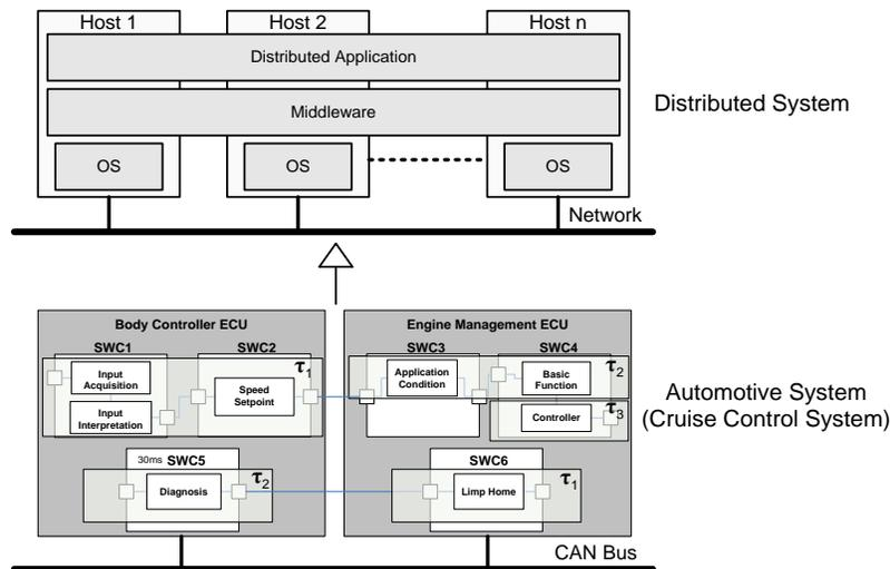
**Figure 1. Système Distribué et Système Distribué Automobile**
