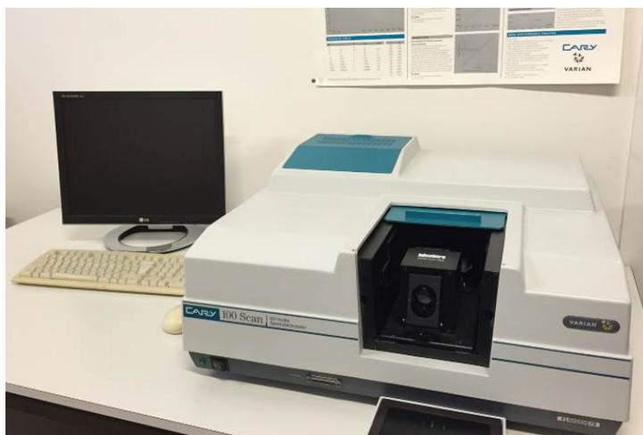
Figure II-17 Spectrophotomètre UV-Vis VARIAN Cary 100 Scan
