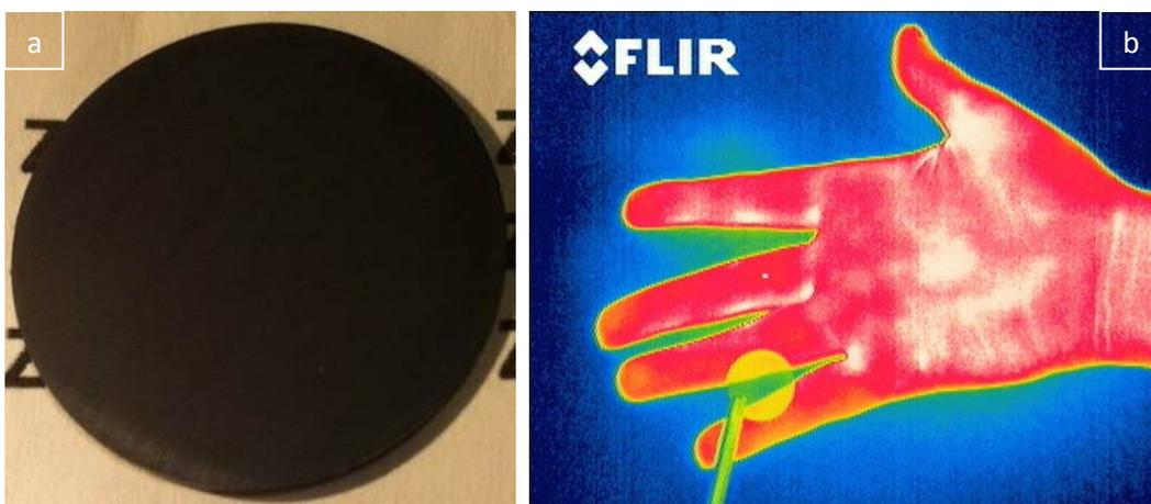
Figure IV-17 Photographie d'une céramique ZnS préparée par frittage HP d'une poudre précipitée (a) et Image IR au travers de celle-ci (b)
