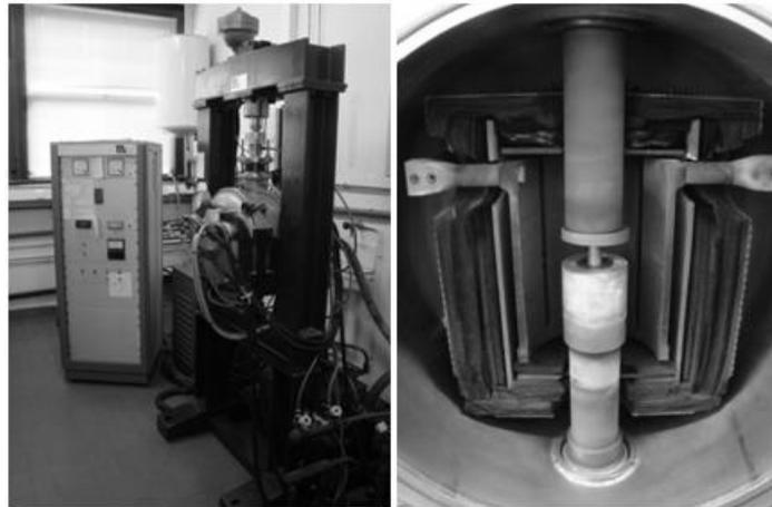
Figure II-7 Photographies du dispositif hot pressing, vue extérieure (à gauche); intérieur du four avec moule en graphite en position sur la presse (à droite)
