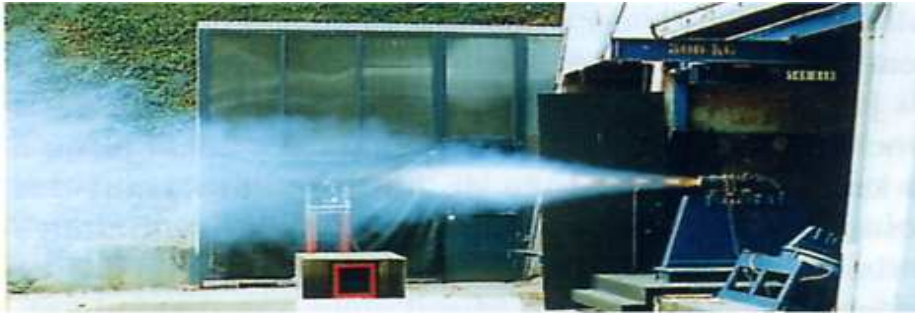
figure II.12 - Jet de propulseur composite faiblement chargé en additifs métalliques dans le visible : mise en évidence de la zone d'adaptation à la pression externe et de la recombustion
