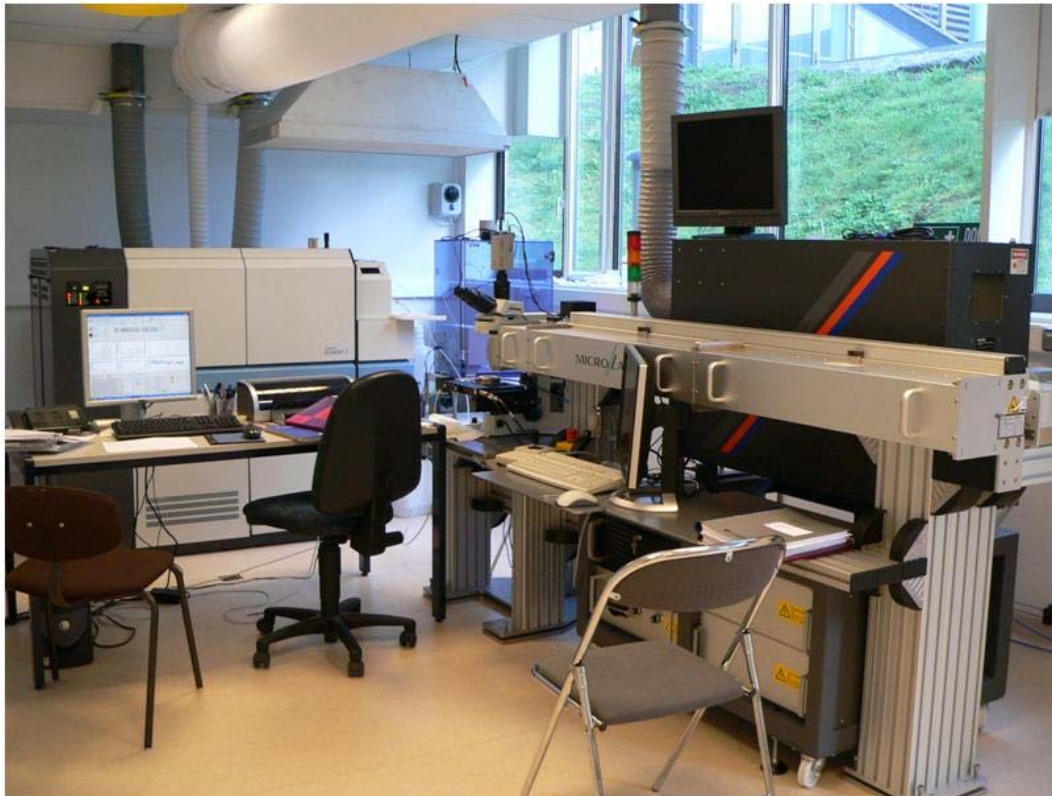
Figure II.69 : Vue générale de l'ICP-MS Thermo Element 2 du laboratoire Domaines océaniques de Brest couplée à un système d'ablation laser (LA-ICP-MS).
