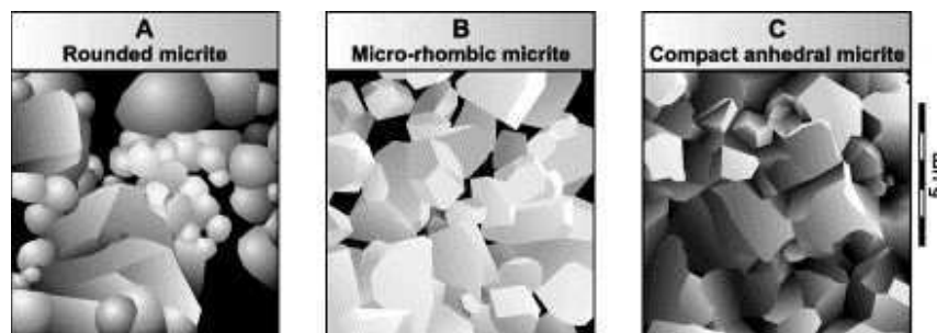
Figure 4.2. : Classification des nanostructures micritiques proposée par Lambert et al. (2006).
