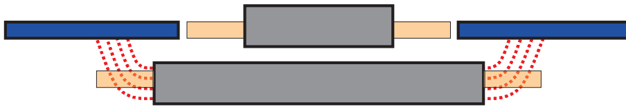
Figure A1-4. Flux de fuites 3D au niveau des plaques de blindage
