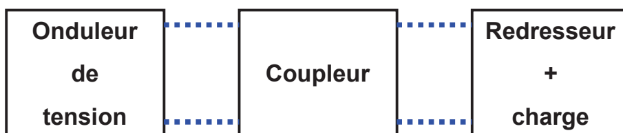
Figure 1-13. Représentation sous forme de schéma bloc de la chaîne de conversion
