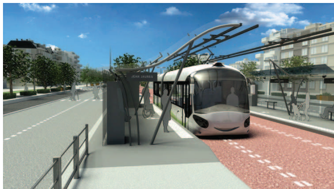
Figure 1-3. Inter station de "biberonnage" de l'e-BRT (Source : [SIEMENS])
