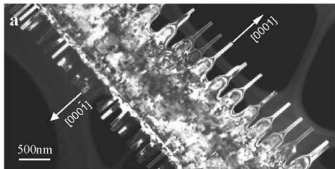
**Figure 2.9** – Croissance secondaire de nanofils de ZnO sur les flancs [0001] et [000-1] d'un nanoruban de ZnO[78].
