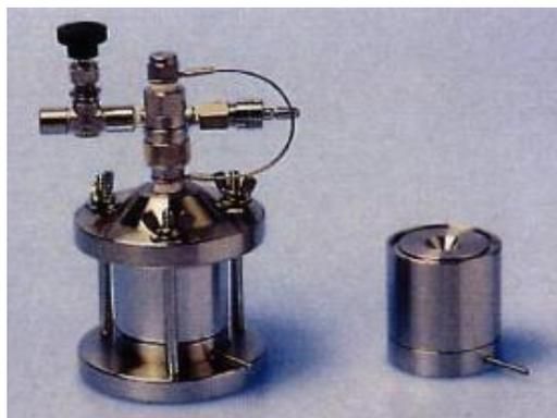
Figure 27 : extrudeuse à pression d'azote
