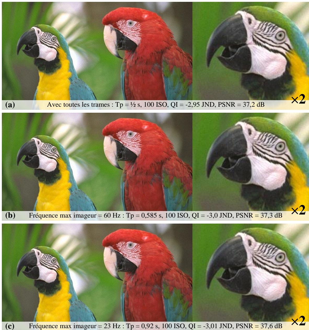
Figure 88. Rendu de l'architecture de stabilisation d'image avec consigne de qualité fixée à -3 JND utilisant la technique de l'augmentation du temps de pose. (a) Image initiale comprenant toutes les trames. (b) Image avec seulement les trames générées à une fréquence inférieure à 60 Hz. (c) Image avec seulement les trames générées à une fréquence inférieure à 23 Hz. Pour visualiser les résultats correctement, attention à la résolution d'impression couleur (>180 dpi) ainsi qu'à la distance de visualisation (48,5 cm).
