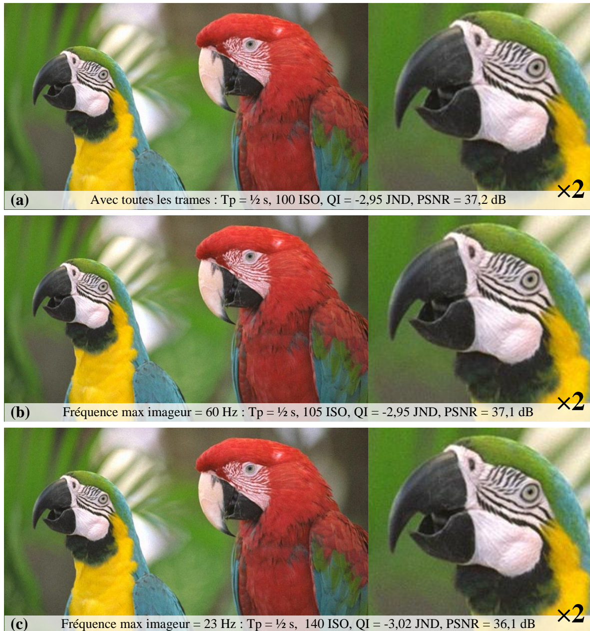
Figure 89. Rendu de l'architecture de stabilisation d'image avec consigne de qualité fixée à -3 JND utilisant la technique de l'augmentation de l'ISO. (a) Image initiale comprenant toutes les trames. (b) Image avec seulement les trames générées à une fréquence inférieure à 60 Hz. (c) Image avec seulement les trames générées à une fréquence inférieure à 23 Hz.
