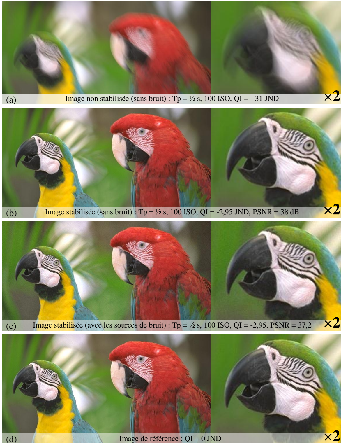
Figure 84. Rendu visuel de l'architecture de stabilisation d'une prise de vue. (a) Image non stabilisée. (b) Image stabilisée (sans les sources de bruit parasites). (c) Image stabilisée (avec simulation du bruit). (d) Image de référence (scène). Pour visualiser les résultats correctement, attention à la résolution d'impression couleur (>180 dpi) ainsi qu'à la distance de visualisation (48,5 cm).
