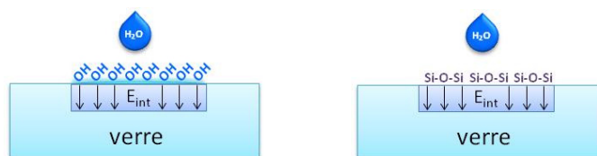
Figure 15 : Schémas des interfaces des lames polarisées étudiées respectivement sous air et sous argon.
