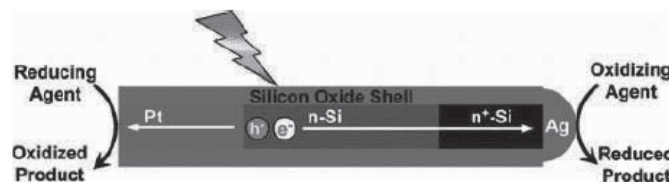
Figure II- 8: Utilisation des nanofils de silicium pour la réalisation de photo-catalyseurs à spectre large 29 .
