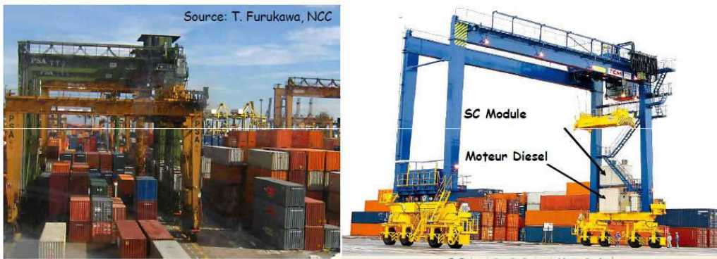
Figure I- 5: Grues aéroportuaires au Japon combinant un moteur diesel et des modules de supercondensateurs 14 .
