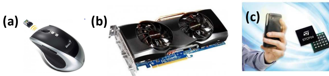
Figure I- 6: Diverses applications courantes des supercondensateurs: (a) souris sans fils équipée de supercondensateurs pour une recharge instantanée 30 (Genius DX-Eco). (b) Carte graphique équipée de supercondensateur de type NEC Proadlizer 31 . (c) Cellule utilisant des supercondensateurs pour améliorer les flashes de téléphone portable 32 .
