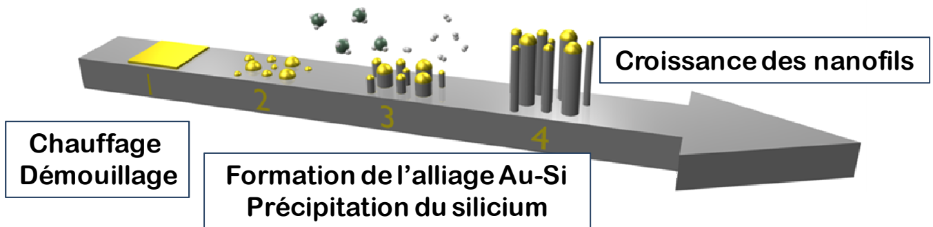
Figure II- 12: Schéma des différentes étapes se produisant dans le mécanisme VLS: (1) Dépôt du catalyseur d'or par évaporation, (2) Démouillage du film mince d'or sur le substrat de silicium, (3) Injection des gaz de croissance, formation de l'alliage liquide Au-Si, sursaturation du silicium dans le catalyseur d'or et (4) précipitation de silicium solide pour former les nanofils.
