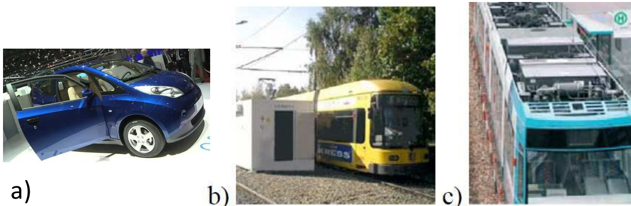
Figure I- 4: Application des supercondensateurs dans le domaine du transport. (a) Voiture électrique "Blue Car" de Bolloré utilisée pour le service Autolib 18 . Véhicule hybride lourd de la plateforme expérimentale ECCE 17 utilisée par la DGA. (b) Utilisation du système SITRA SES de Siemens en station du tramway de Dresde 22 (Allemagne). (c) Utilisation du système MITRAC sur le tramway de Manheim 23 (Allemagne).
