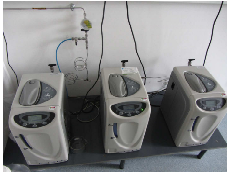
Figure II- 38: Générateurs de dihydrogène utilisés pour fournir le dihydrogène pendant les croissances CVD
