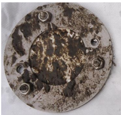
Figure 44 - Vue d'un POCIS après 15 jours d'exposition dans la rivière en amont de la STEP sur le site B
