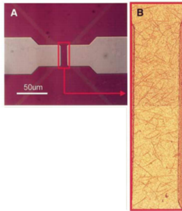
Figure 1.5 – CNTFET conçu en utilisant un réseau de nanotubes de carbone entre des électrodes métalliques [13]
