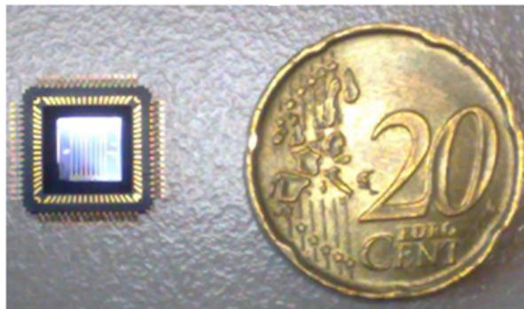
Figure 1.17 – Capteur de gaz à base de CNTFET encapsulé dans un boîtier miniaturisé (encapsulation finale prévue) [39].
