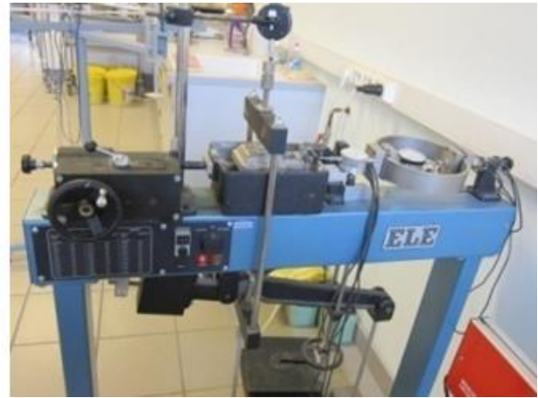
Figure IV.7. Dispositif général d'essai à la boîte de Casagrande
