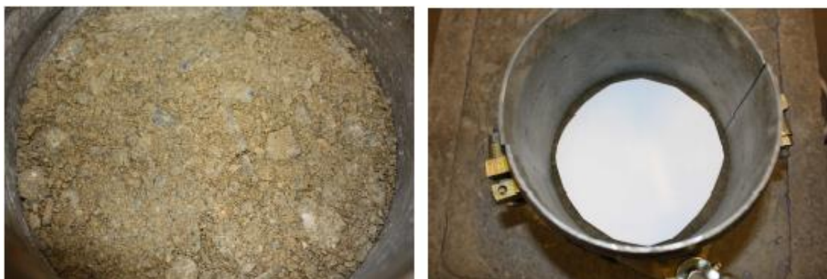
Figure B.7. Insertion du papier filtre dans l'échantillon de la GNT de Maraîchères
