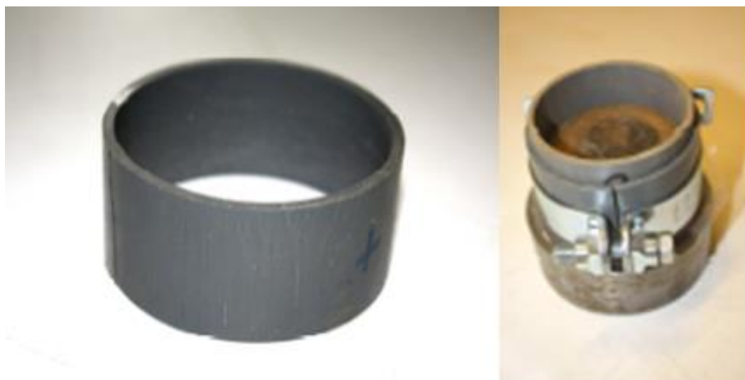
Figure B.3. Moule de l'échantillon du sable de Missillac
