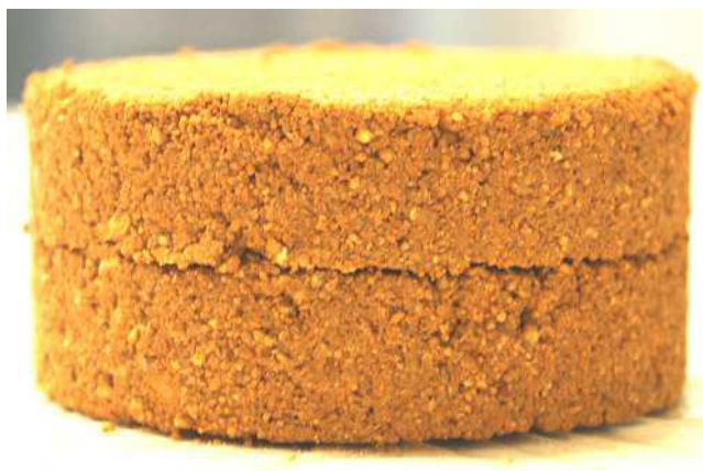
Figure B.5. Echantillon de sable de Missillac après insertion de papier filtre
