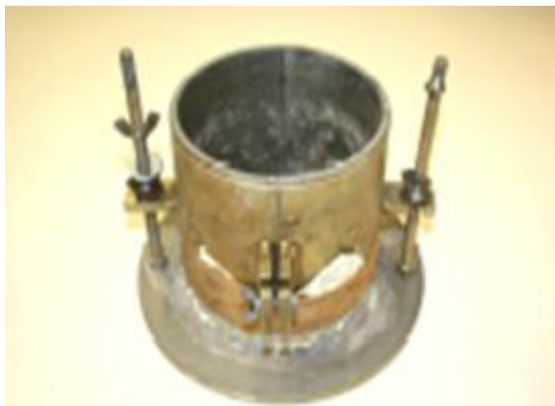
Figure B.4. Moule de l'échantillon de la GNT de Maraînières
