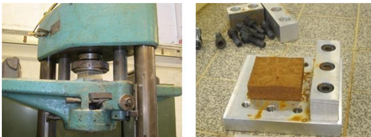
Figure IV.6. Fabriquer l'échantillon de sable de Missillac
