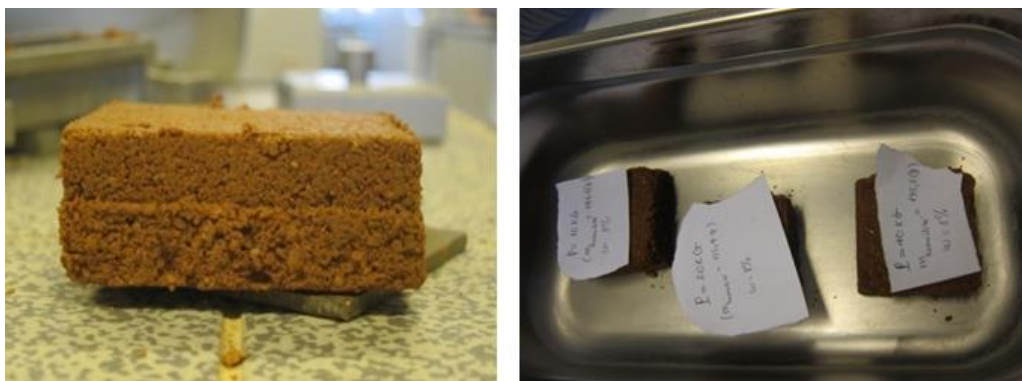
Figure IV.11. Mesurer la teneur en eau finale
