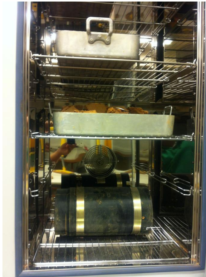
Figure IV.14. Séchage de l'échantillon
