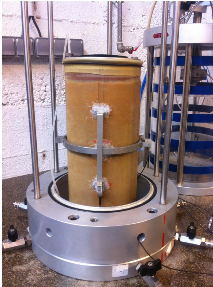
Figure II.5. Echantillon pour essais triaxiaux à chargements répétés avec les capteurs de déformations axiales et déformation radiale
