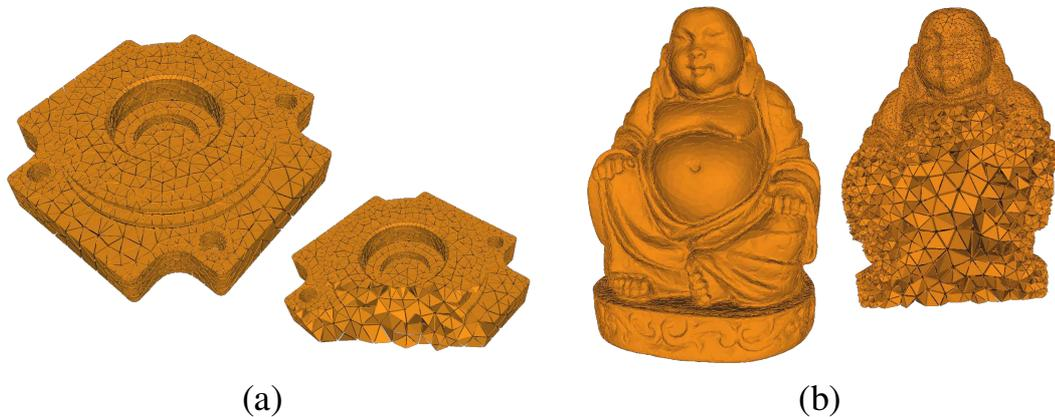
**FIGURE 4.2** : Maillages utilisés pour l'évaluation monorésolution. Le modèle Coverrear (a) avec 4051 sommets, 20650 arêtes, 29767 faces et 13167 volumes. Le modèle Buddha (b) avec 45177 sommets, 264375 arêtes, 413744 faces et 194545 volumes.
