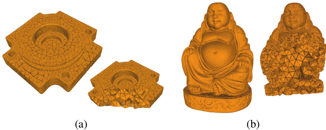
FIGURE 4.2 : Maillages utilisés pour l'évaluation monorésolution. Le modèle Coverrear (a) avec 4051 sommets, 20650 arêtes, 29767 faces et 13167 volumes. Le modèle Buddha (b) avec 45177 sommets, 264375 arêtes, 413744 faces et 194545 volumes.
