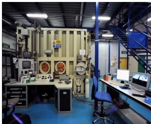
Photographie III-2 : Caisson hypobare de l'IRBA. (Source : photographie personnelle).
