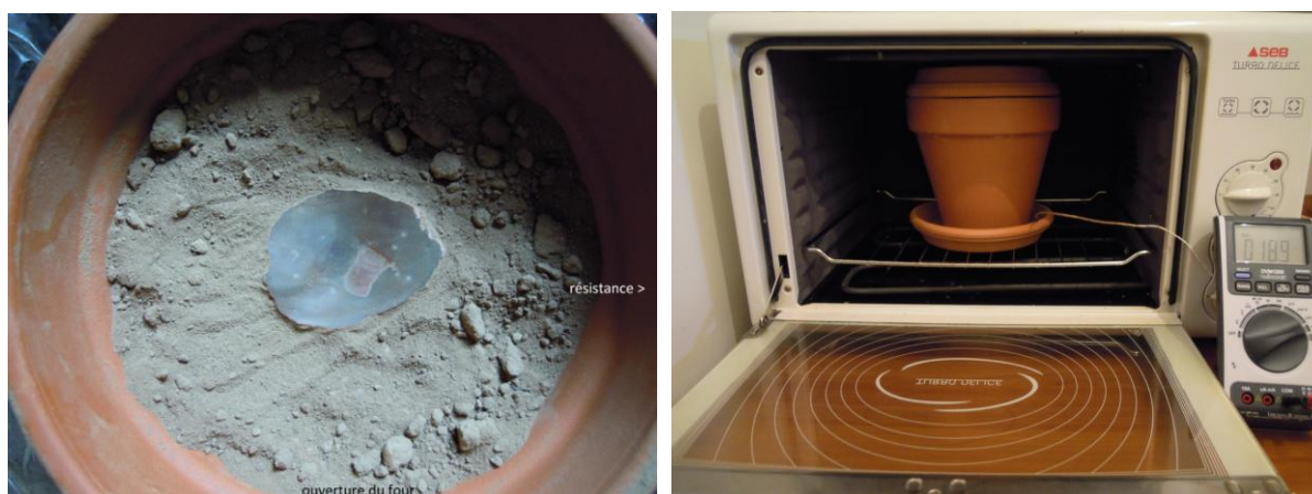
Fig. 65 : Nucléus 915.94.21P plongé dans le sable de molasse et placé dans un four de cuisine. La sonde du thermocouple est en contact avec le nucléus (photos L. Torchy).
