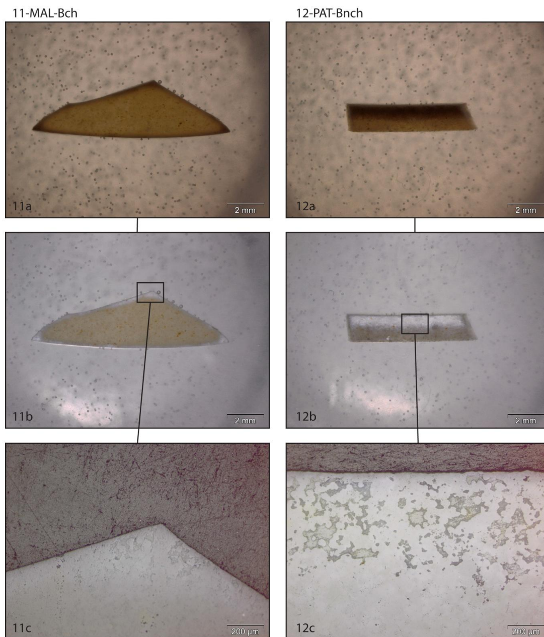
Fig. 112 : Observation des deux échantillons « patinés ». Comme en témoigne la comparaison des photos en réflexion et en transmission, la patine blanche est un effet visuel engendré par une différence de porosité (Photos L. Torchy).
