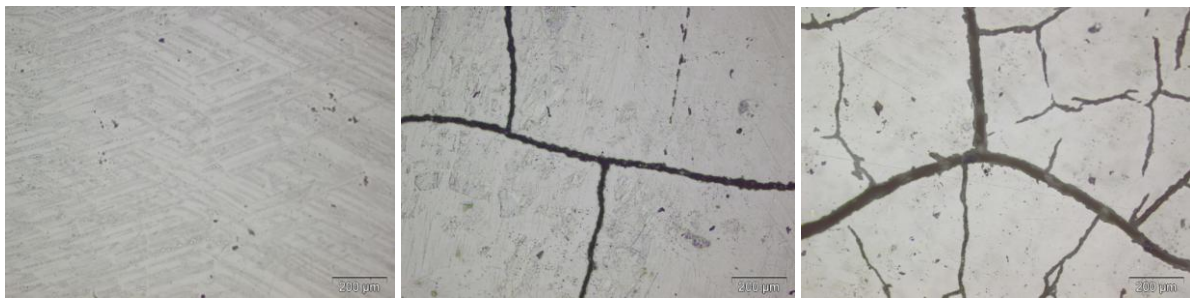
Fig. 54 : Changements colorimétriques et fissuration (de gauche à droite : 400°C, 500°C et 600°C). Le silex est de plus en plus foncé puis devient gris entre 500°C et 600°C, pendant ce temps plusieurs réseaux de fissures se forment (photos L. Torchy).
