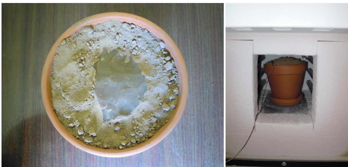
Fig. 60 : Nucléus 915.94.21V plongé dans le sable de molasse et placé dans le four. La sonde du thermocouple est en contact avec le nucléus (photos L. Torchy).
