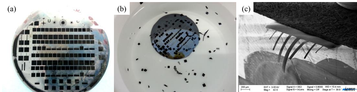
Figure IV.16: (a) Image de la plaquette de silicium après gravure du semi-RIP conducteur. (b) image de la plaquette après 10 minutes d'immersion dans l'eau et (c) image MEB de peignes de microactionneurs de tailles décroissantes après 72h de gonflement dans EMImTFSI.
