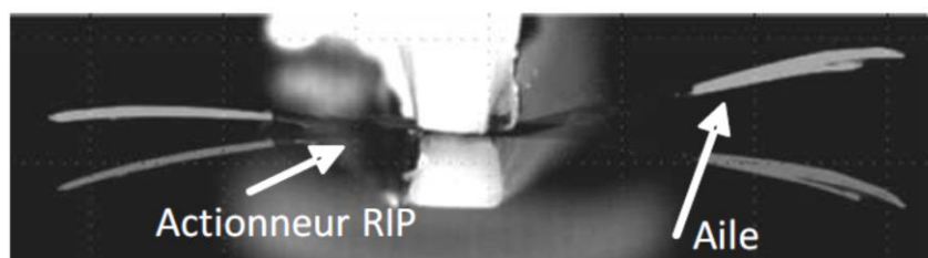
Figure I.18: Ailes artificielles de Tipules actionnées par un RIP conducteur POE/PTHF/PEDOT (masse totale ailes+actionneur = 2,4 mg, f = 24 Hz, I = 44 mA, E = \pm 5V )
