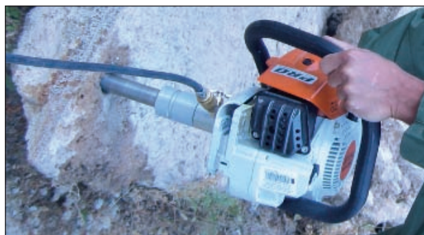
Figure A.62. Carottier à moteur thermique utilisé pour le prélèvement des travertins.
