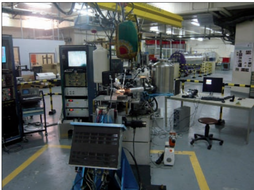
Figure A.64. Le dispositif AGLAE (Accélérateur Grand Louvre d'Analyse Élémentaire) ; l'accélérateur électrostatique est le cylindre gris à l'arrière-plan.
