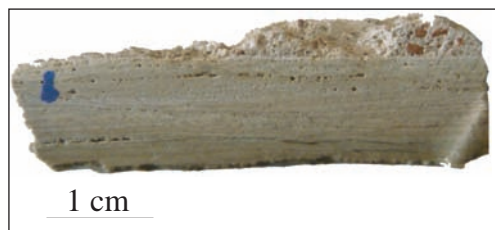
Figure B.91. Echantillon de travertin montrant le faciès C3 (état 5) de la salle T6 des thermes.
