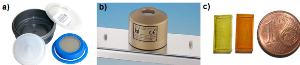
FIGURE 3 – a) Badge de prélèvement passif. b) Capteur de COVt (PID SLG-instruments). c) Matériau nanoporeux pour mesure optique de la société Ethera [Nguyen 2013]
