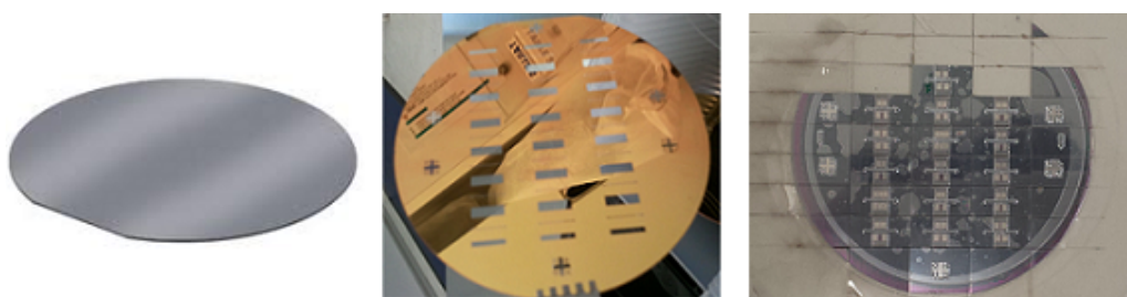
FIGURE 3.1 – Un wafer avant (gauche), pendant (milieu) et après process et découpe (droite)
