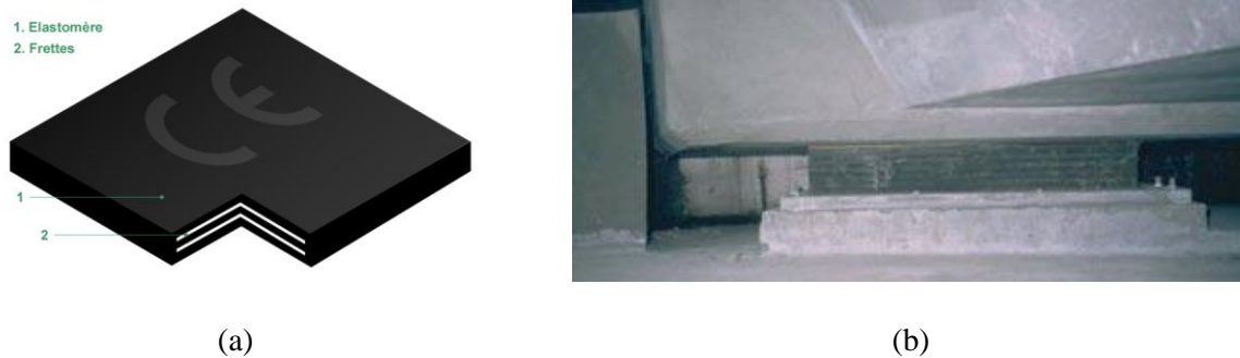
Figure 19. Schéma (a) et photo (b) d'un appareil d'appui en néoprène fretté (Source SNAC).
