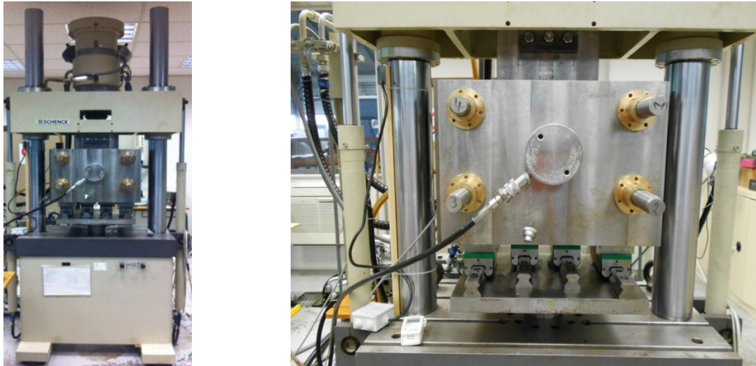
Figure 55 : Photos du dispositif biaxial à l'état d'achèvement (vue suivant l'axe de compression).
