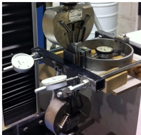
Figure 40 : Photo du dispositif biaxial pendant l'essai.
