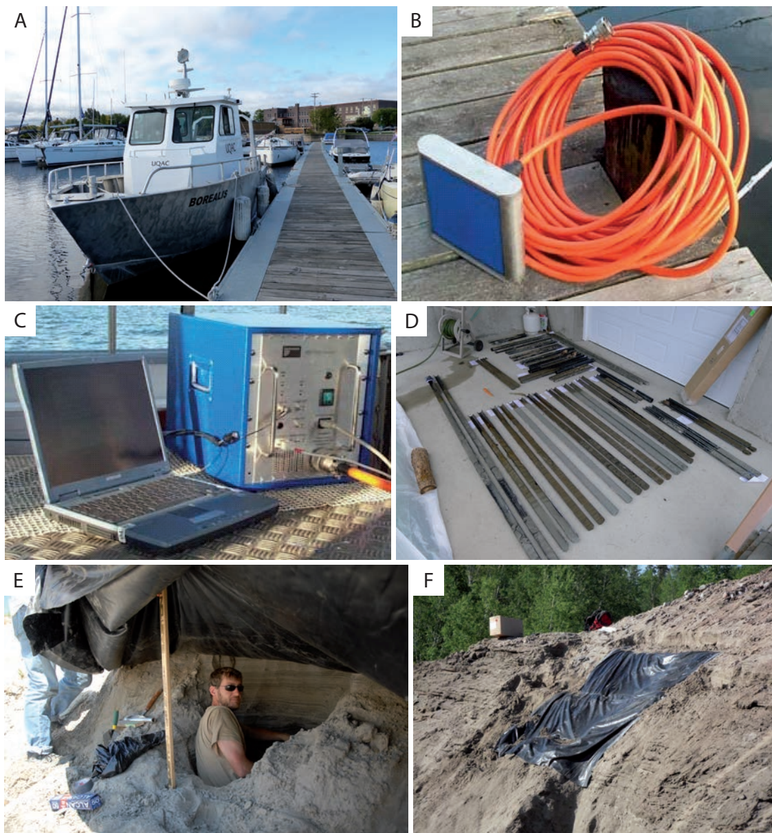
Fig. II-13. Acquisition de données sismiques, carottage et échantillonnage pour datation. A) Bateau Borealis (Université du Québec à Chicoutimi) qui a servi à l'acquisition des données géophysiques. B) Transducteur SES 2000 Compact utilisé pour l'acquisition des données géophysiques. C) Génératrice SES 2000 Compact utilisée pour l'acquisition des données géophysiques. D) Vue d'ensemble des 22 carottes du fond du lac après ouverture. E) Préparation de la fosse pour l'échantillonnage OSL. F) Échantillonnage sous bâche dans l'obscurité.
