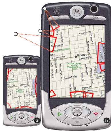
FIGURE 4.10 – Aperçu de la technique Wedge [Gustafson 08]. À gauche, les indications de direction sont données par les arcs de cercle de la technique City Lights . Des chevauchements sont visibles, et gênent la lisibilité. À droite, les mêmes informations sont données par la technique Wedge . L'algorithme adapte la taille des indices visuels pour empêcher les chevauchements.
