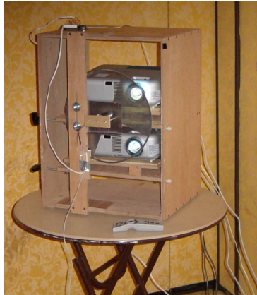
FIGURE 1.12 – Projections stéréoscopiques low-cost et multi-murales. Images tirées de [Miller 05].
