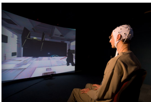
FIGURE 4.13 – L’application « Use-the-force » utilise une interface cerveau-ordinateur pour soulever des objets virtuels. Image tirée de [Renard 10].
