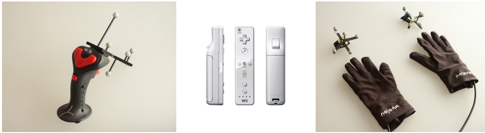
FIGURE 1.3 – Les périphériques d’interaction de la plateforme de réalité virtuelle IN VIRTUO. De gauche à droite : le flystick, la Wiimote et les gants de données.
