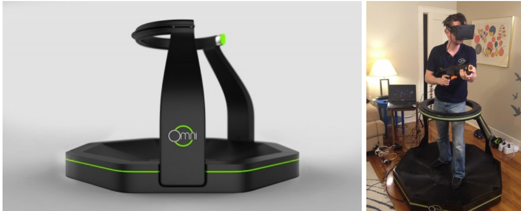
FIGURE 2.12 – Le Virtuix Omni TM offre la possibilité de se déplacer librement dans le monde virtuel en marchant ou même en courant. Images tirées de [Virtuix 13].
