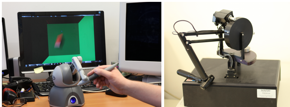
FIGURE 1.4 – Les périphériques haptiques Phantom (Omni et Desktop) de la plateforme de réalité virtuelle IN VIRTUO.
