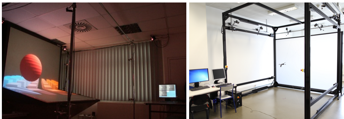
FIGURE 1.2 – Les systèmes de visualisation de la plateforme de réalité virtuelle IN VIRTUO. À gauche : le Workbench. À droite : le mur immersif.
