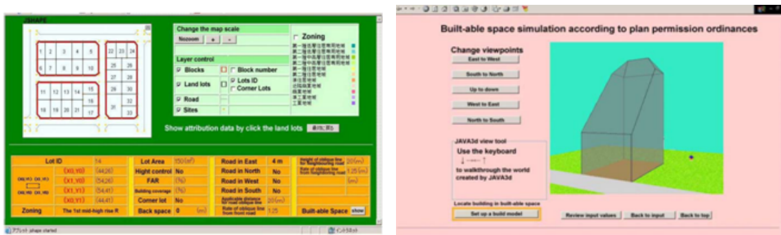
FIGURE 1.20 – Interfaces utilisateurs web (Shen et Kawakami, 2004). À gauche, l’interface de définition des règles appliquées et à droite, l’interface de visualisation de l’enveloppe constructible.
