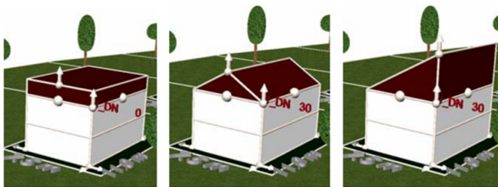
FIGURE 1.21 – Utilisation de Gizmos influant sur les caractéristiques du bâtiment (forme de toit, hauteur, etc.) (Coors et al. , 2009).
