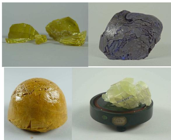
Figure 42 : Échantillons de fondants et de couleurs vitrifiables en masse
