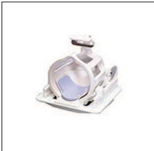
**Figure 23.** Antenne tête utilisée pour homogénéiser le champ magnétique autour des huîtres.
