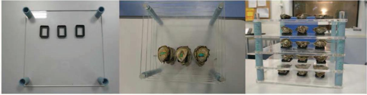
*Figure 24. Système de plateaux conçu pour l'imagerie des huîtres.*
