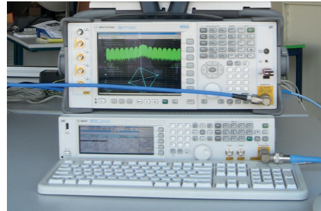
Generator MXG N5182 & Analyzer MXA N9020A
