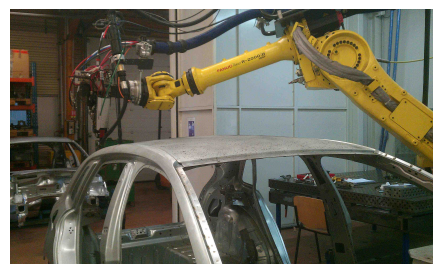
(b) Caisse en blanc de la Citroën C4, utilisée pour les essais de validation
