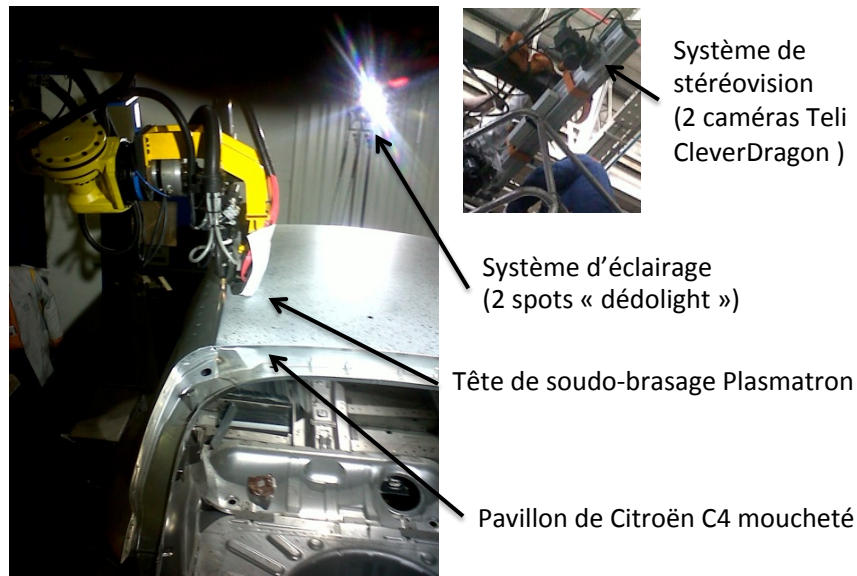
FIGURE 4.16: Montage expérimental utilisé lors du nouvel essai de stéréocorrélation
