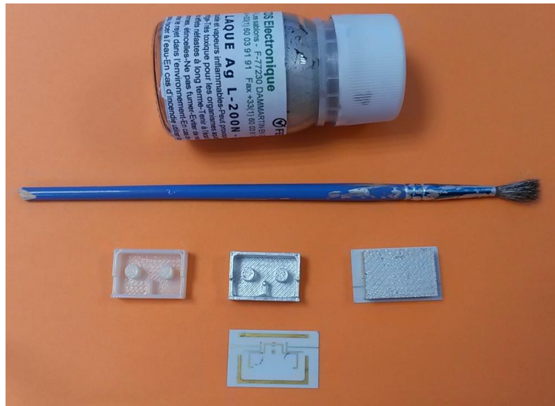
Figure IV.41. Fabrication et métallisation de la cavité en plastique
