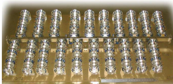
Figure I.10. Filtre d'OMUX à 20 canaux
