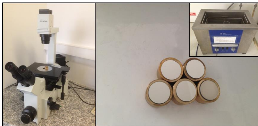
Figure 2.1.3. Microscope optique Olympus IX70 équipé un objectif X50 (à gauche), échantillons polis à la silice colloïdale et appareil ultrasonique utilisé pour le nettoyage des substrats (à droite)
