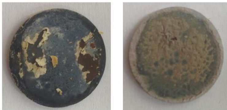
Figure 2.1.5. Délaminage du dépôt de Ca-P à cause de traitement thermique à 700 (à gauche) et 800°C (à droite)
