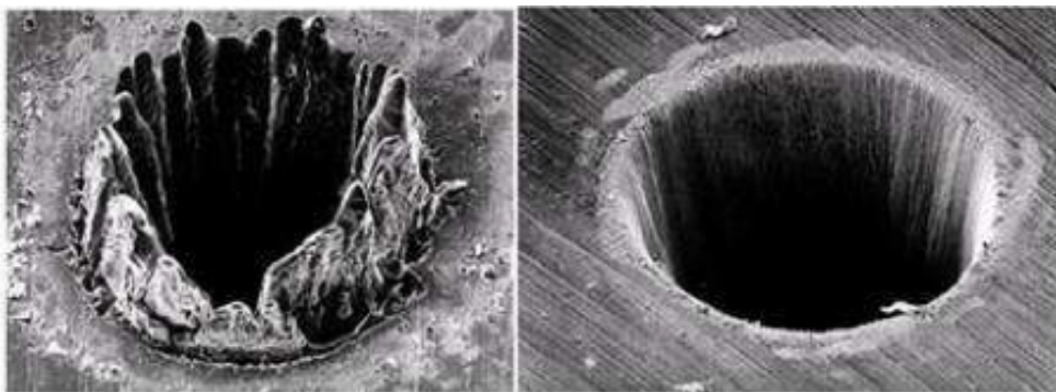
FIGURE 1.4 – Découpe laser d'un matériau composite (verres renforcées à la fibre de carbone) réalisée en régime d'impulsions nanosecondes (gauche) et femtosecondes (droite) [5].
