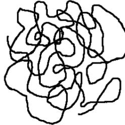
*Figure 1-1 : Représentation schématique d'un polymère non réticulé sous forme de pelote statistique (Figure extraite de la référence 5)*
