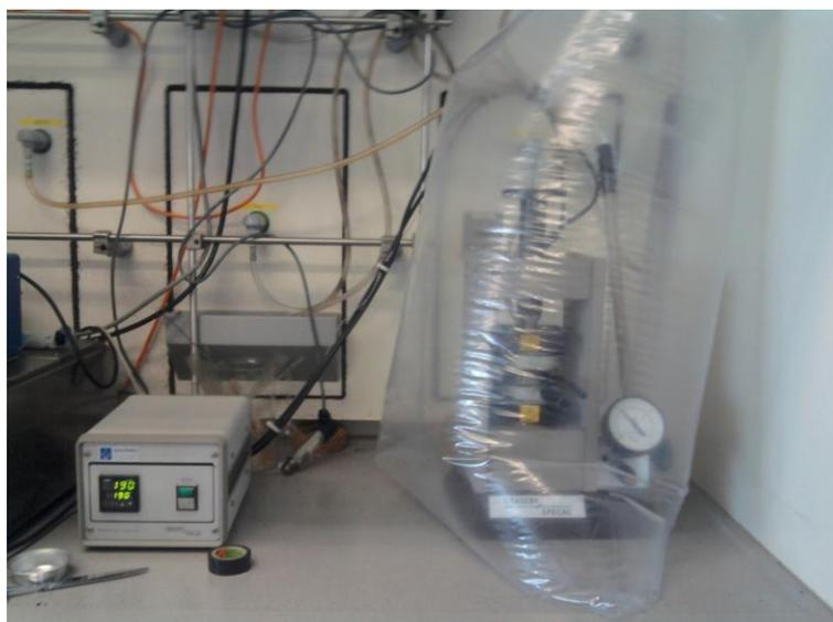
*Figure 5-4 : montage utilisé pour la vulcanisation des élastomères sous atmosphère inerte*
