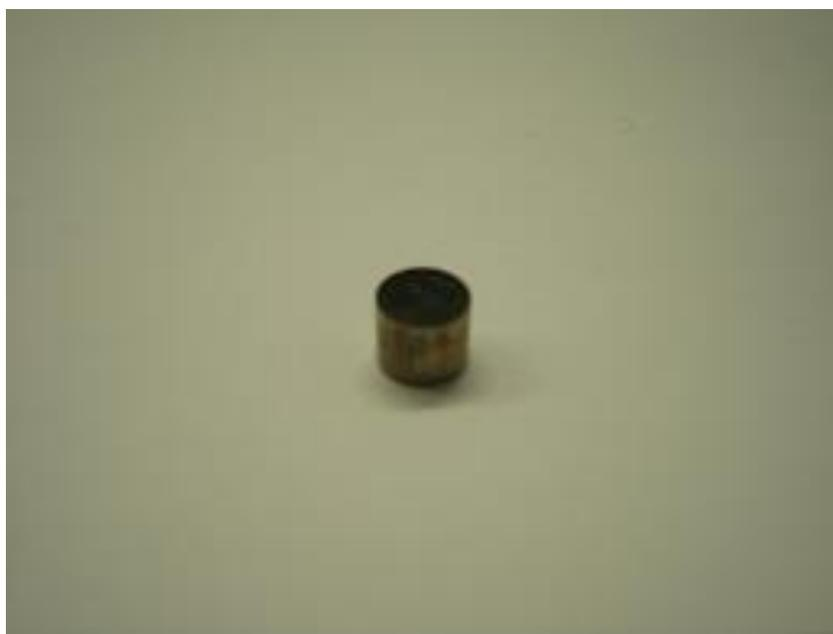
Figure 2.2 : Electrode de VACNFs/TiO<sub>x</sub>/Ti obtenue par CCVD et polie suivant les paramètres décrits ci-dessus.
