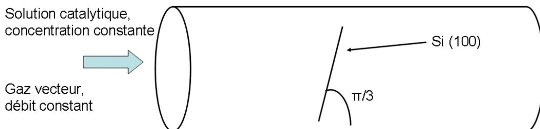
Figure 2.5 : Représentation de la synthèse CCVD sur un substrat Si(100).
