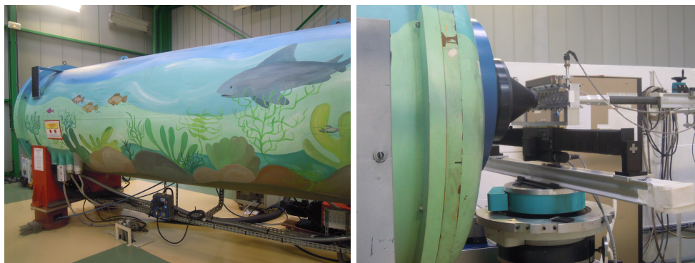
FIGURE 2.7 – Photos du spectromètre PAXE prise en novembre 2011. A gauche le tube sous vide qui sépare l'échantillon du détecteur. A droite, le porte échantillon
