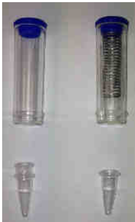
Figure 4. Vues des différentes modifications apportées au vials CESI-MS. A gauche vial CESI8000 et tube PCR standard. A droite les mêmes éléments ont été modifiés permettant l'injection d'échantillon dont la quantité est faible.
