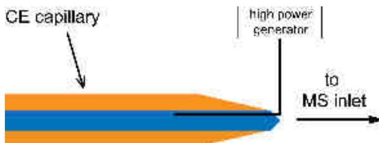
Figure 25. Représentation schématique d'interface CE-ESI-MS sheathless utilisant un fil conducteur inséré dans le capillaire.
