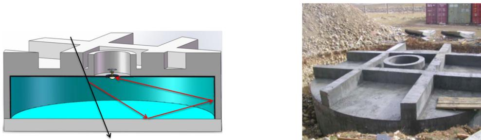
FIGURE 5.7 – Schéma d'une cuve Cherenkov du MD-KM2A (gauche) et photo du prototype (droite).
