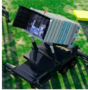
FIGURE 5.5 – Photo d'un télescope Cherenkov du détecteur WFCTA.
