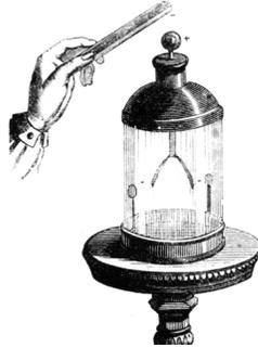
FIGURE 1.1 – Principe de l'électroscope.
