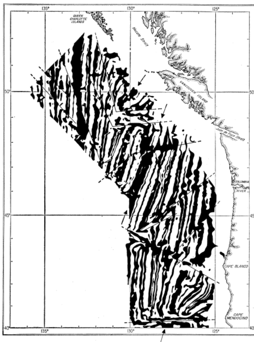
FIGURE 1.1: Diagramme montrant les anomalies de champ magnétique au Sud-Ouest des îles Vancouver. Les anomalies positives sont représentées en noir. Les lignes montrent les décalages causés par des failles transformantes et les flèches les axes des 3 segments de dorsale : Explorer, Juan de Fuca et Gorda (Fig. 1 [Vine, 1966]).
