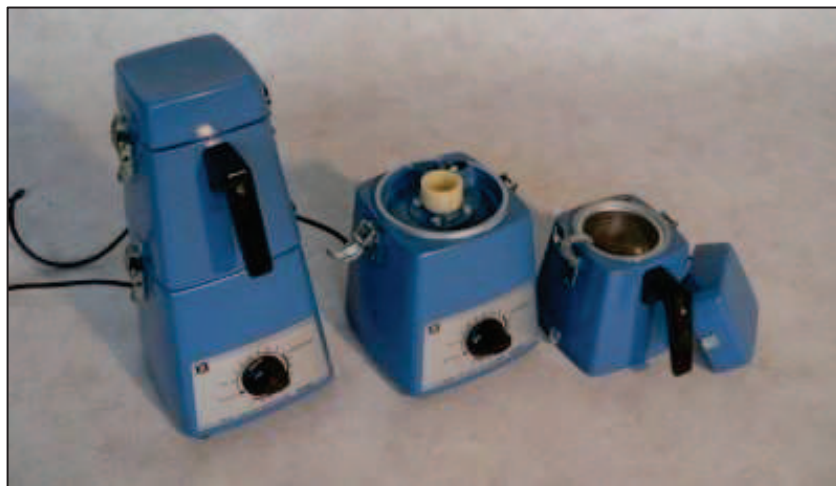
Figure 51 - Broyeur IKA utilisé pour le mélange à sec du ferrite et de \text{Bi}_2\text{O}_3 et \text{Co}_3\text{O}_4
