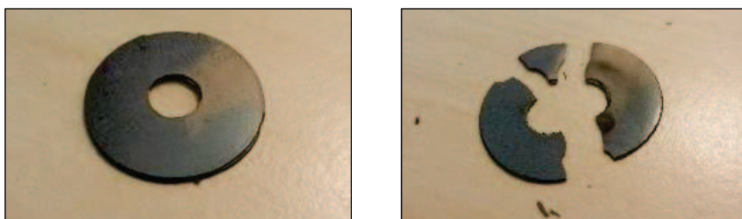
Figure 136 - Tore réalisé par empilement torique, fritté sous charge de 5g (à gauche) et 20g (à droite)
