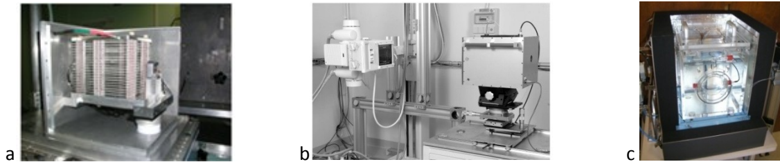
Chambre à parois d'air démontée (a), installée sur le banc du radiodiagnostic(b), et calorimètre-eau(c).
