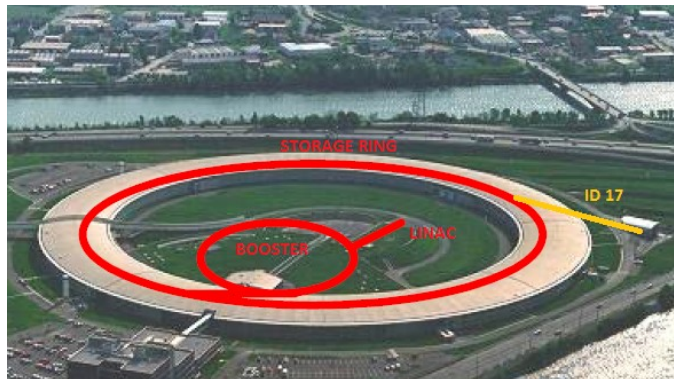
Figure 3-7: vue aérienne de l'ESRF (en rouge les faisceaux d'électrons et en jaune une ligne de rayons X). [11]
