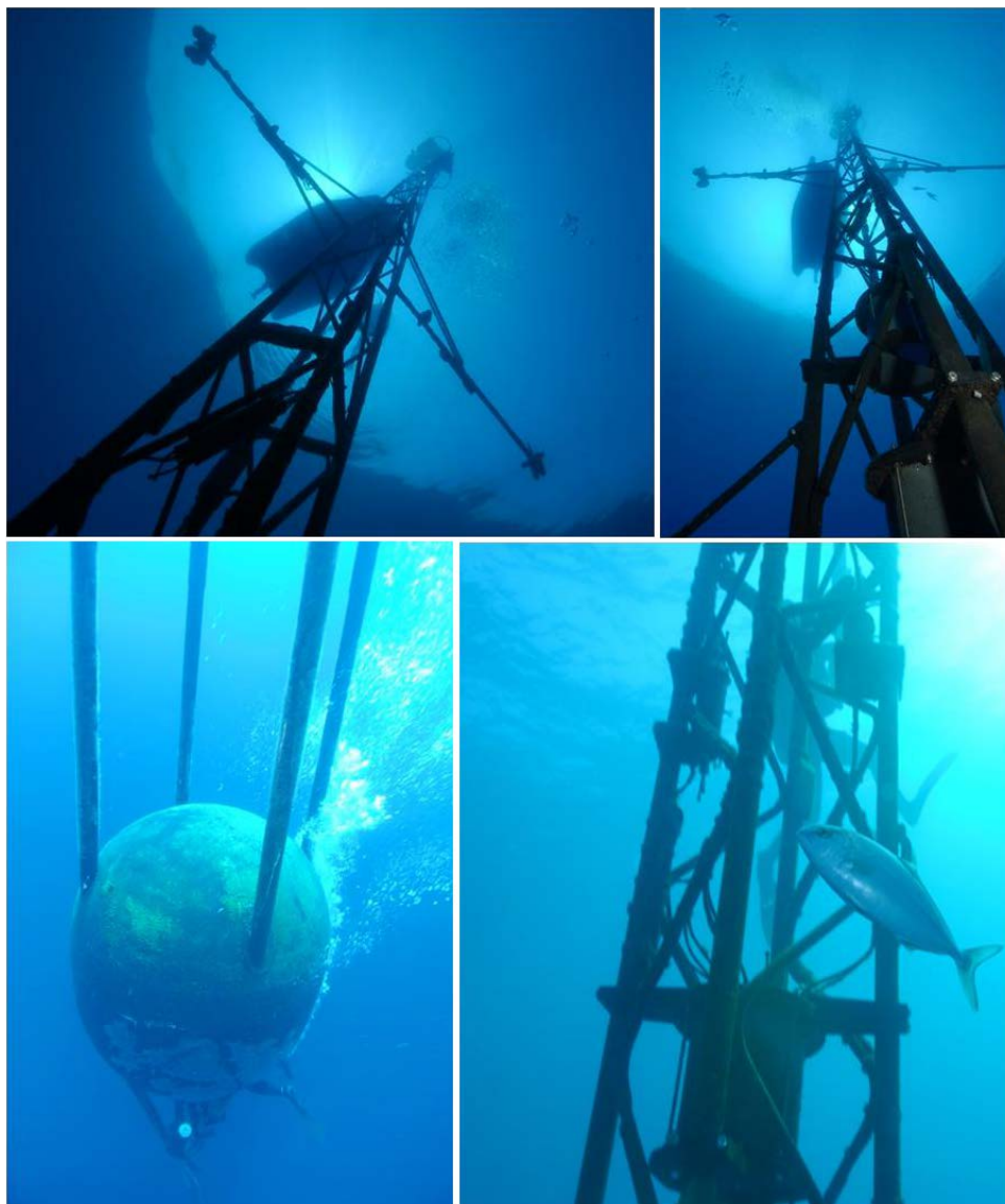
Figure 3-4 : Photographies prise lors de campagnes mensuelles montrant la partie immergée de la bouée. Les capteurs d'éclairément sont fixés à l'extrémité des bras horizontaux pour minimiser l'ombrage.
